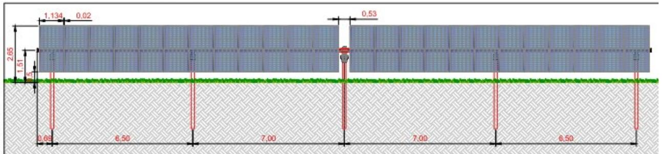
Figura 7-4 – Sezione longitudinale tipologica struttura Tracker
