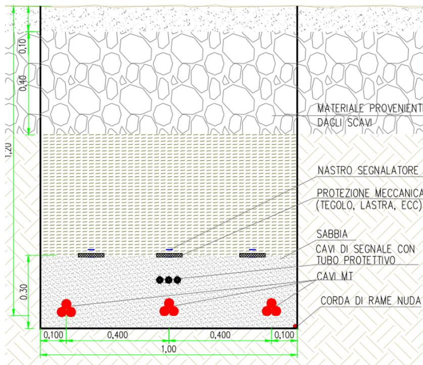
Figura 8-10 – Sezione tipica posa cavi 30 kV
