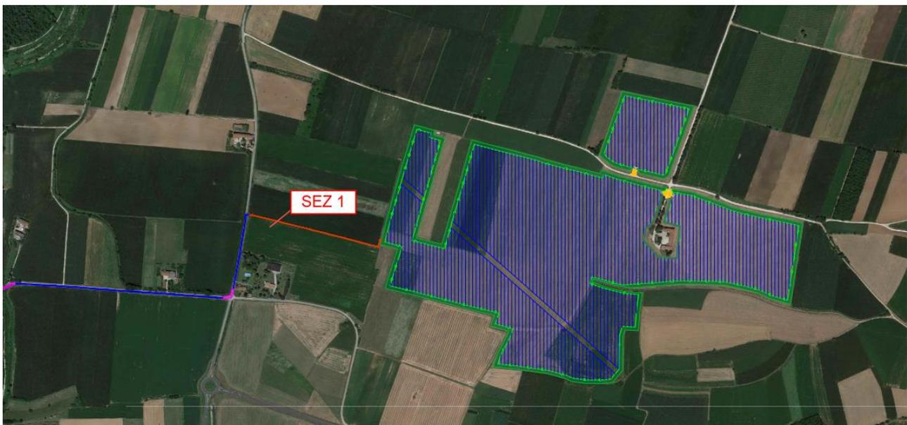
**Figura 91: Individuazione Sezioni cavi elettrodotti 30 kV area Premariacco**
