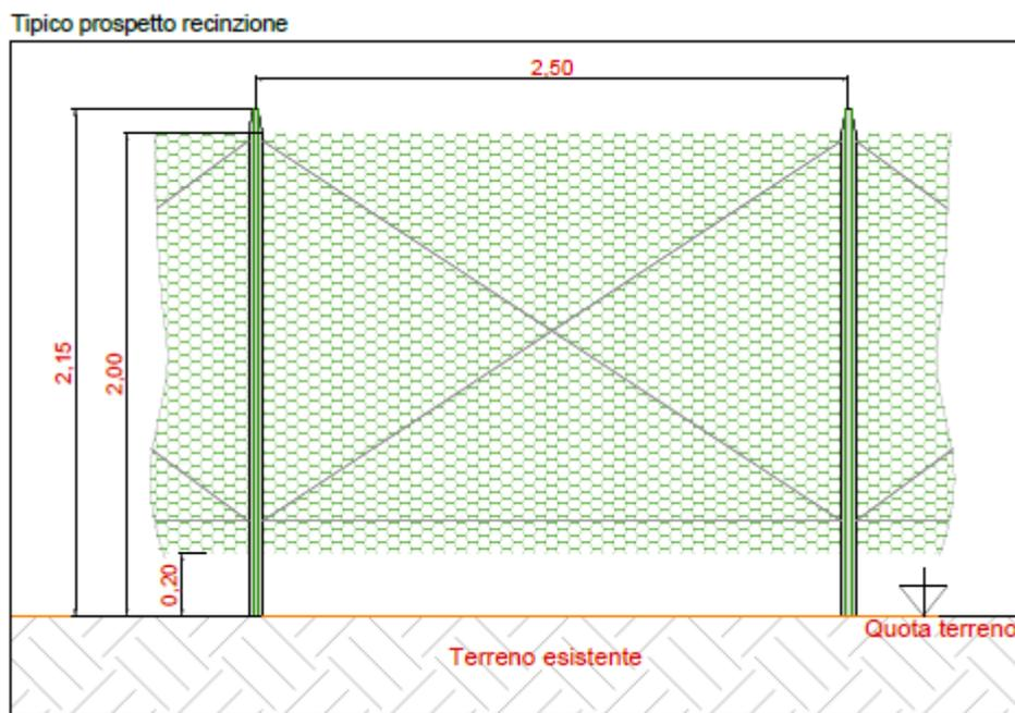
Figura 88: Stralcio tipico recinzione con evidenza delle aperture previste lungo la recinzione per evitare il potenziale effetto barriera
