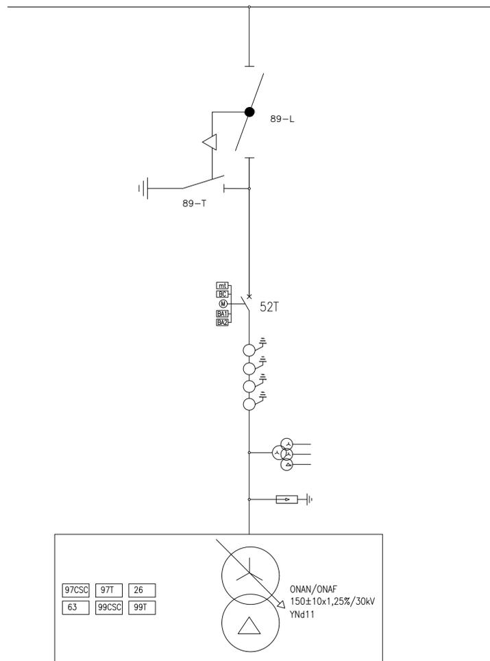
**Schema elettrico unifilare**
