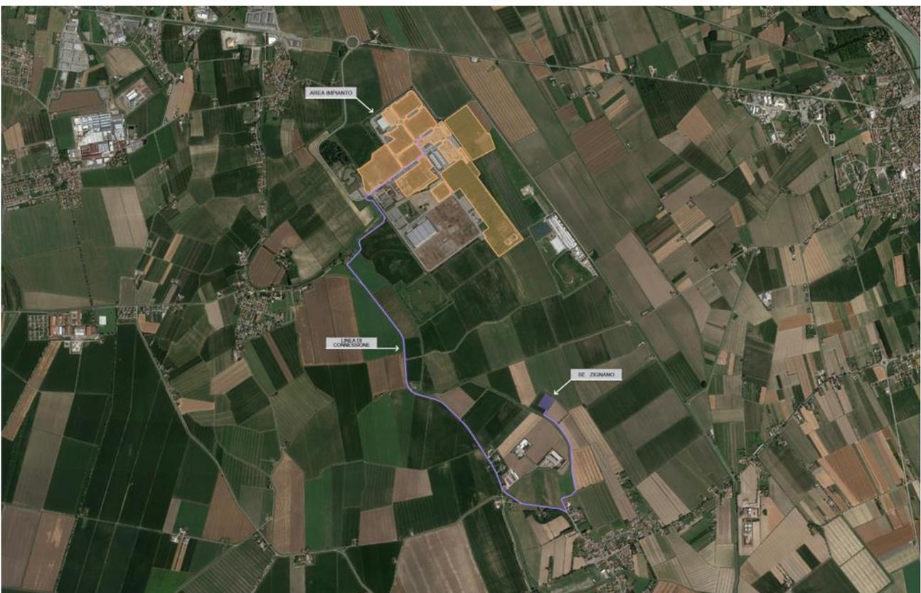
Figura 19 – Cavidotto MT di collegamento con la Sottostazione Elettrica di Utenza
