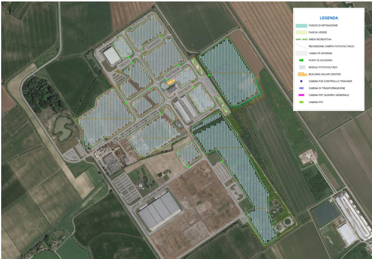
Figure 11 – Layout impianto fotovoltaico
