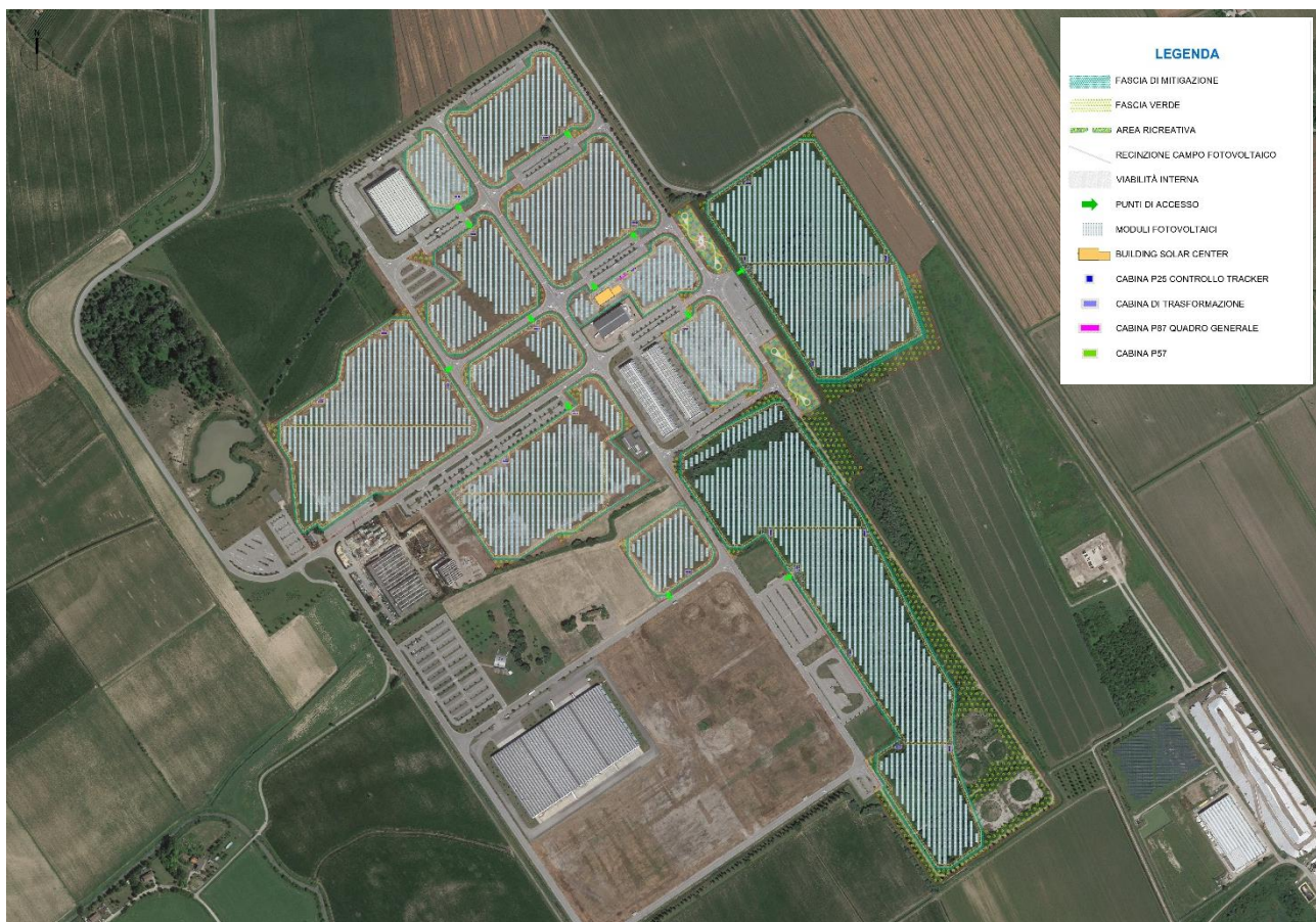
Figura 1 – Inquadramento layout impianto agro-fotovoltaico su ortofoto
