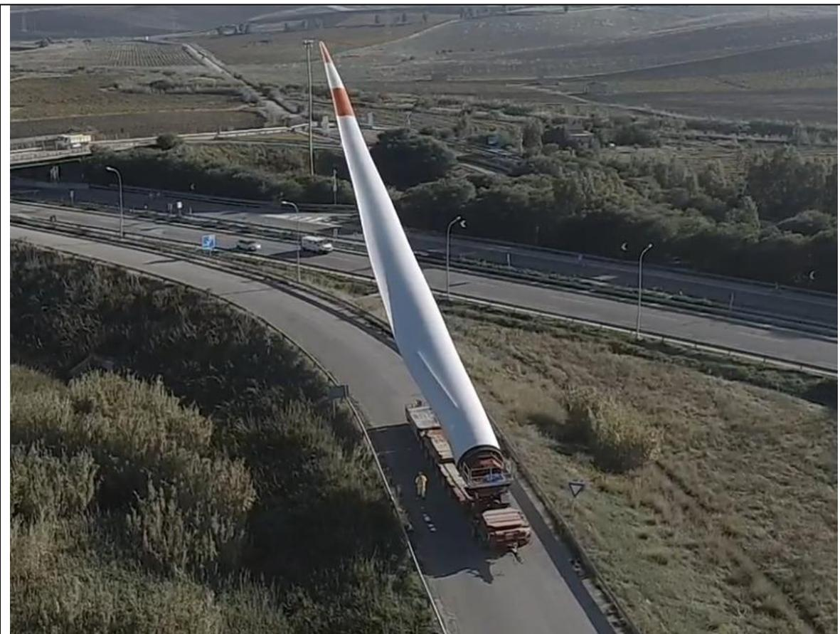
*Figura 65 - Immagine 2 - Blade lifter in azione*
