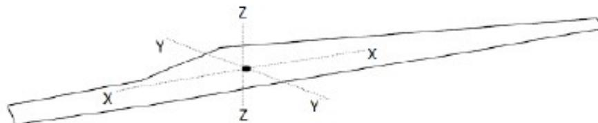
La rotazione della pala intorno all'asse  $zz$  è causato dalla conservazione del momento della quantità di moto: in caso di rottura, per il principio di conservazione, il generico spezzone tende a ruotare intorno all'asse ortogonale al proprio piano. La rotazione intorno agli altri assi è dovuta alle azioni indotte dal vento incidente out of plane sulla pala/sezione di pala.
