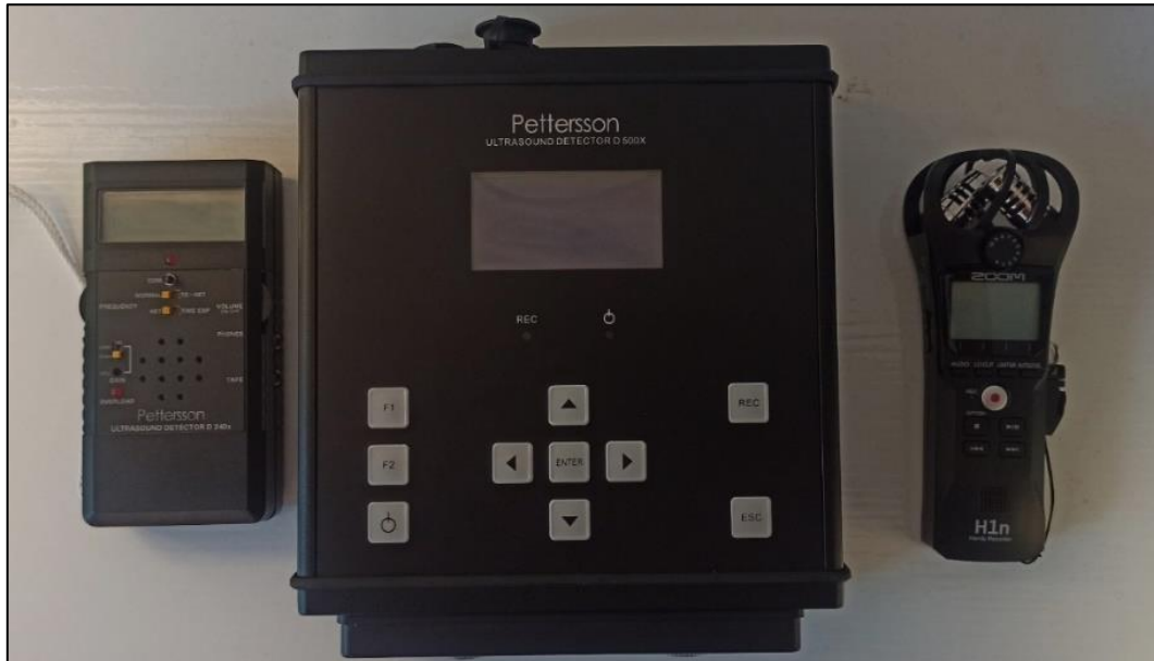
Figura 47 – Attrezzatura utilizzata per il monitoraggio chiroteri. Da sinistra: rilevatore a eterodina ed espansione temporale (x10 e x20 selezionabile), Bat detector D 500X per la registrazione prolungata nel campo degli ultrasuoni, e registratore multitraccia collegato al D 240 X
