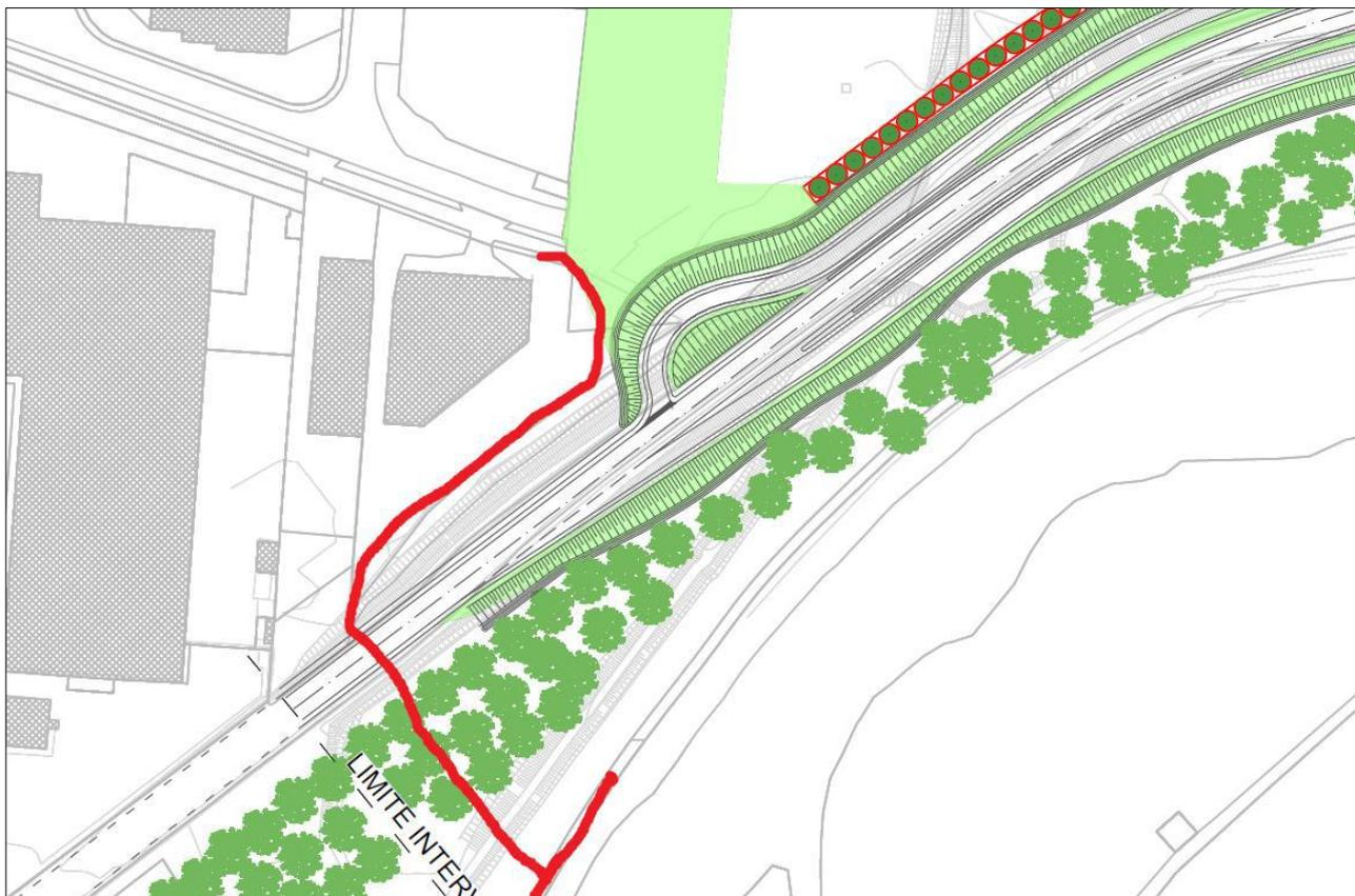
**Figura 3-5 - bozza di possibile tracciato ciclopedonale di collegamento tra piste ciclopedonali esistenti nella zona artigianale a nord della SS e la pista ciclopedonale "Sentiero Valtellina" a sud della SS. Il punto di passaggio è già in studio da alcuni anni e si collocherebbe in una zona idonea anche dal punto di vista idraulico.**
