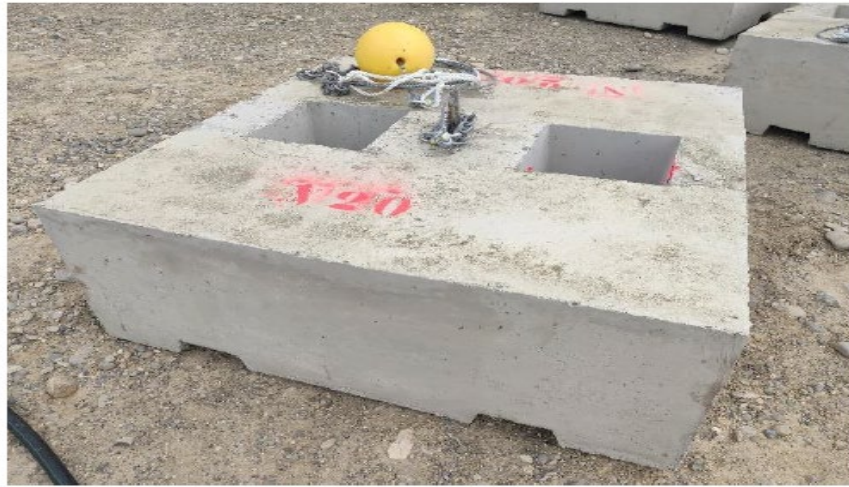
Figura 2-2: Pesi morti in ghisa e cemento debolmente armato
