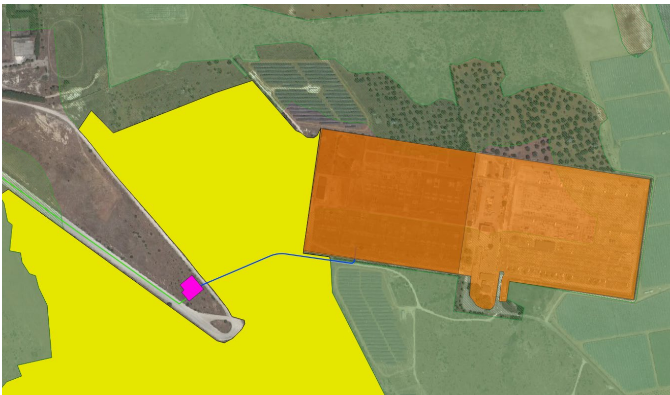
Figura11-9: Dettaglio della porzione di cavidotto AT interrato con tecnica TOC non invasiva (Blu)
