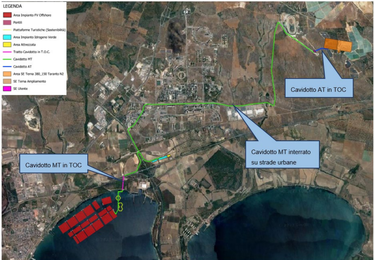
Figura 3-4: Inquadramento territoriale su Ortofoto del percorso del cavidotto di connessione MT e AT
