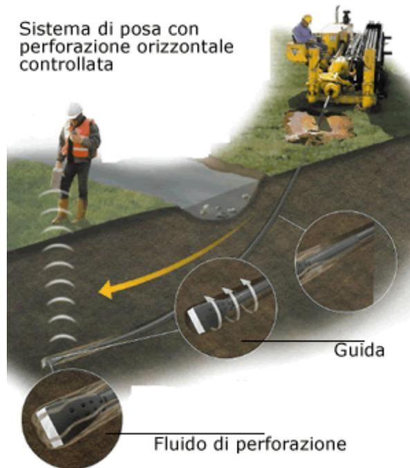
**Figura 6-Sistema di trivellazione orizzontale controllata (T.O.C.).**
