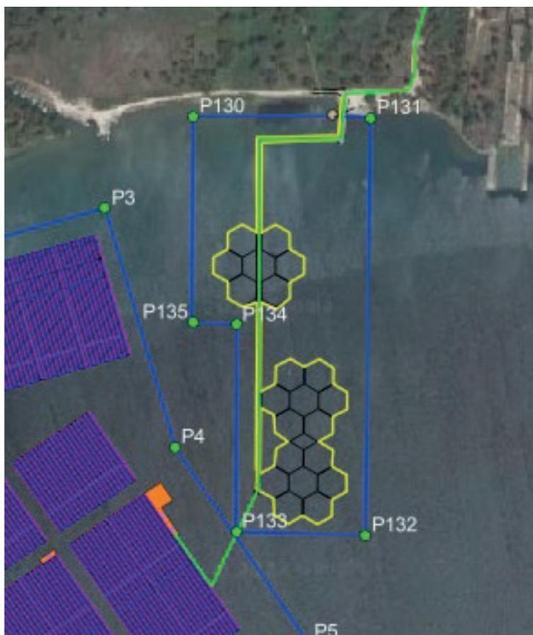
Figura 5-1: Dettaglio planimetrico delle piattaforme galleggianti
