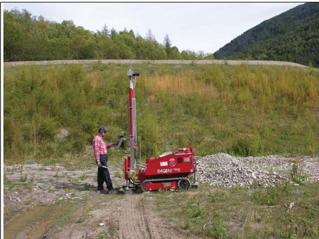
FOTO 6: esecuzione della prova penetrometrica dinamica DPSH4.
