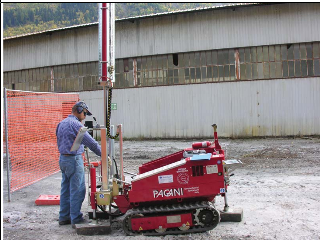
FOTO 9: esecuzione della prova penetrometrica dinamica DPSH7.
