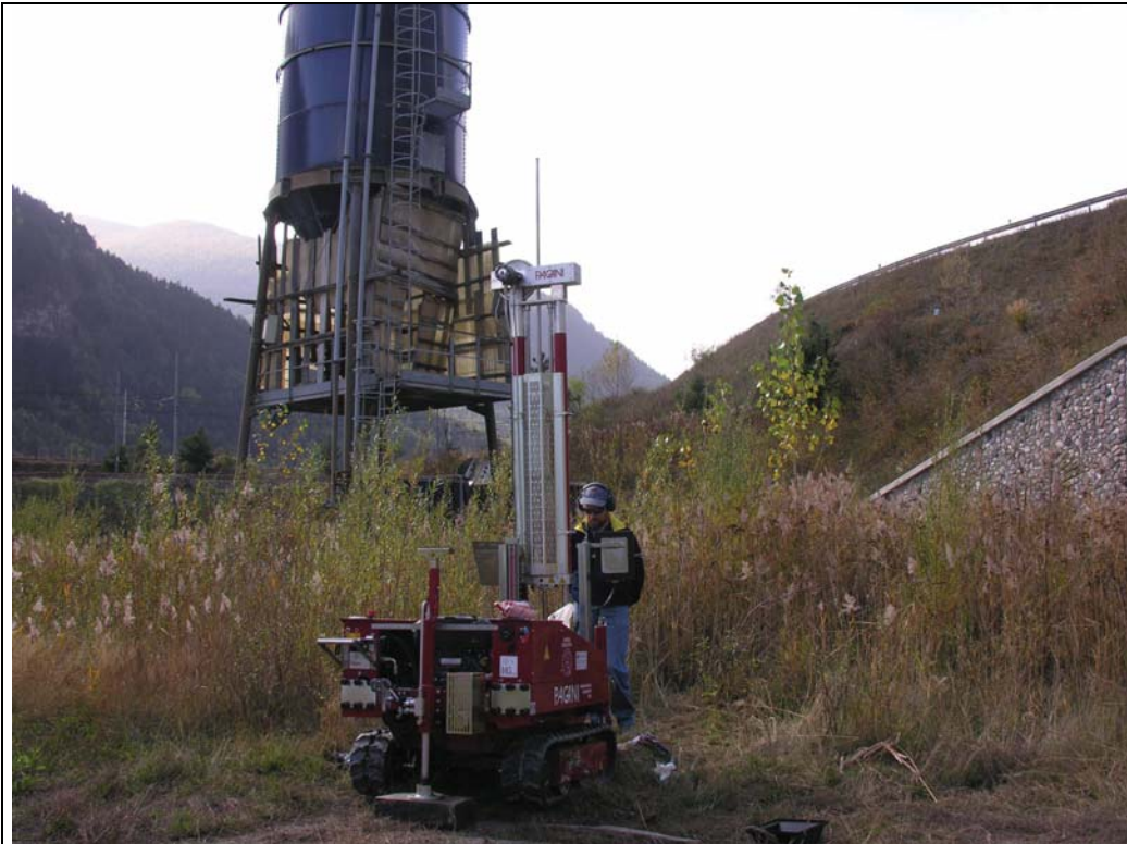
FOTO 8: esecuzione della prova penetrometrica dinamica DPSH6.
