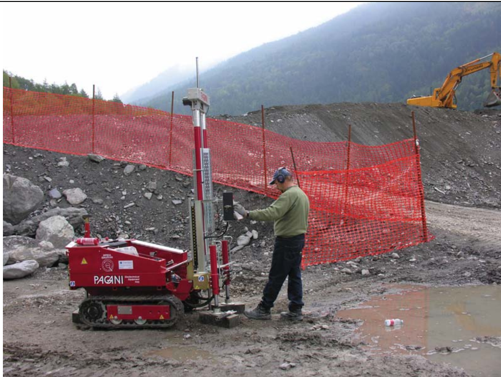
FOTO 4: esecuzione della prova penetrometrica dinamica DPSH2.
