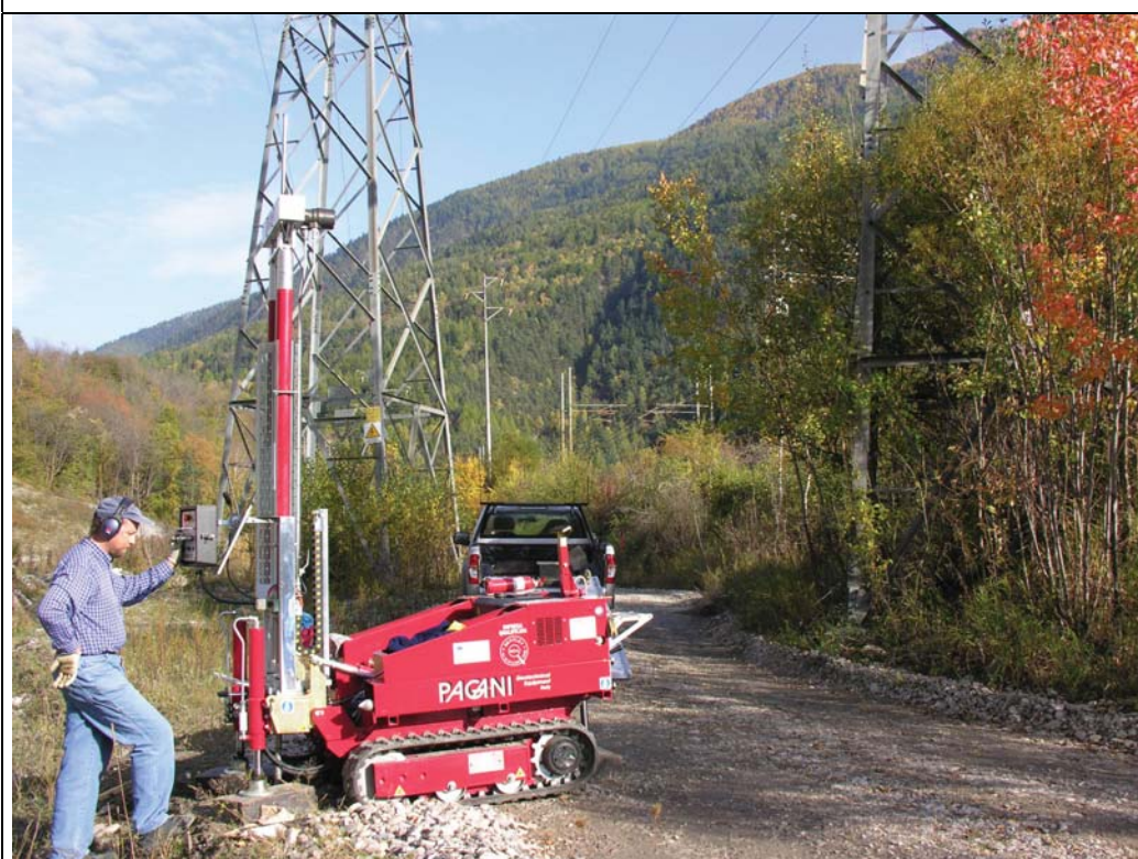
FOTO 7: esecuzione della prova penetrometrica dinamica DPSH5.
