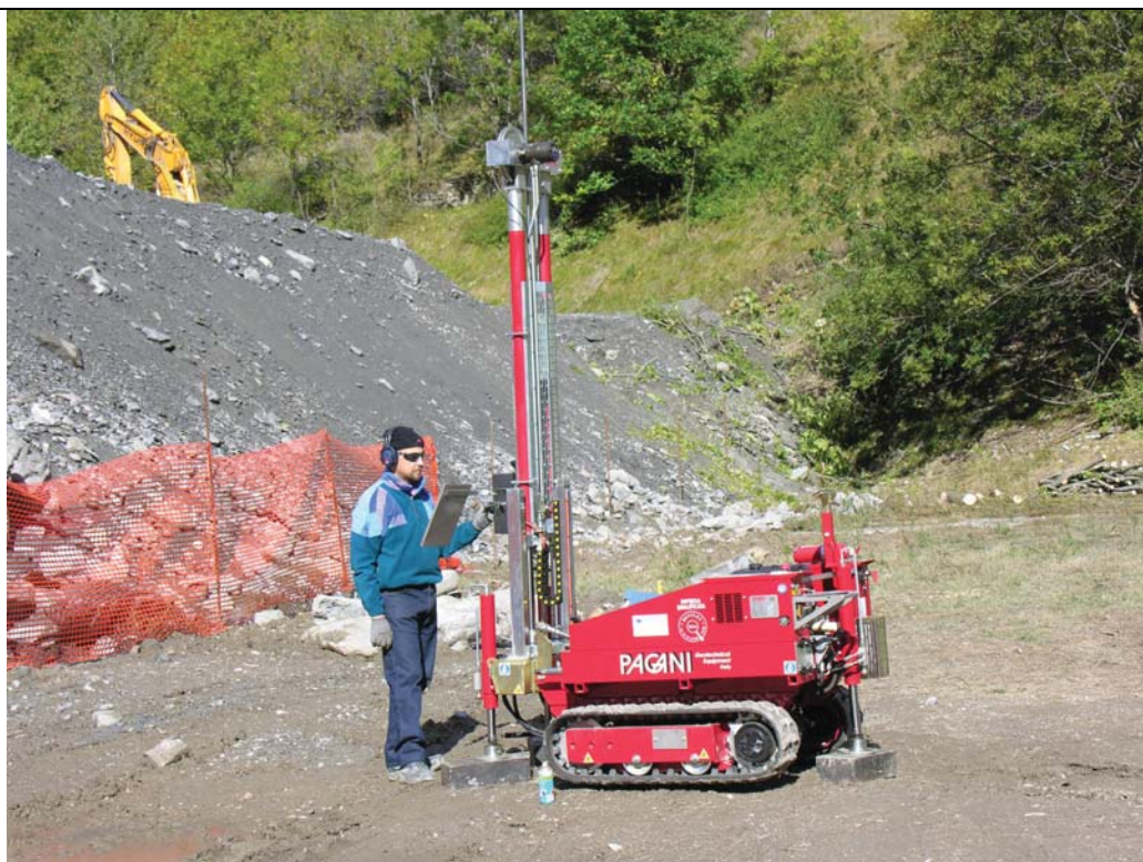
FOTO 5: esecuzione della prova penetrometrica dinamica DPSH3.
