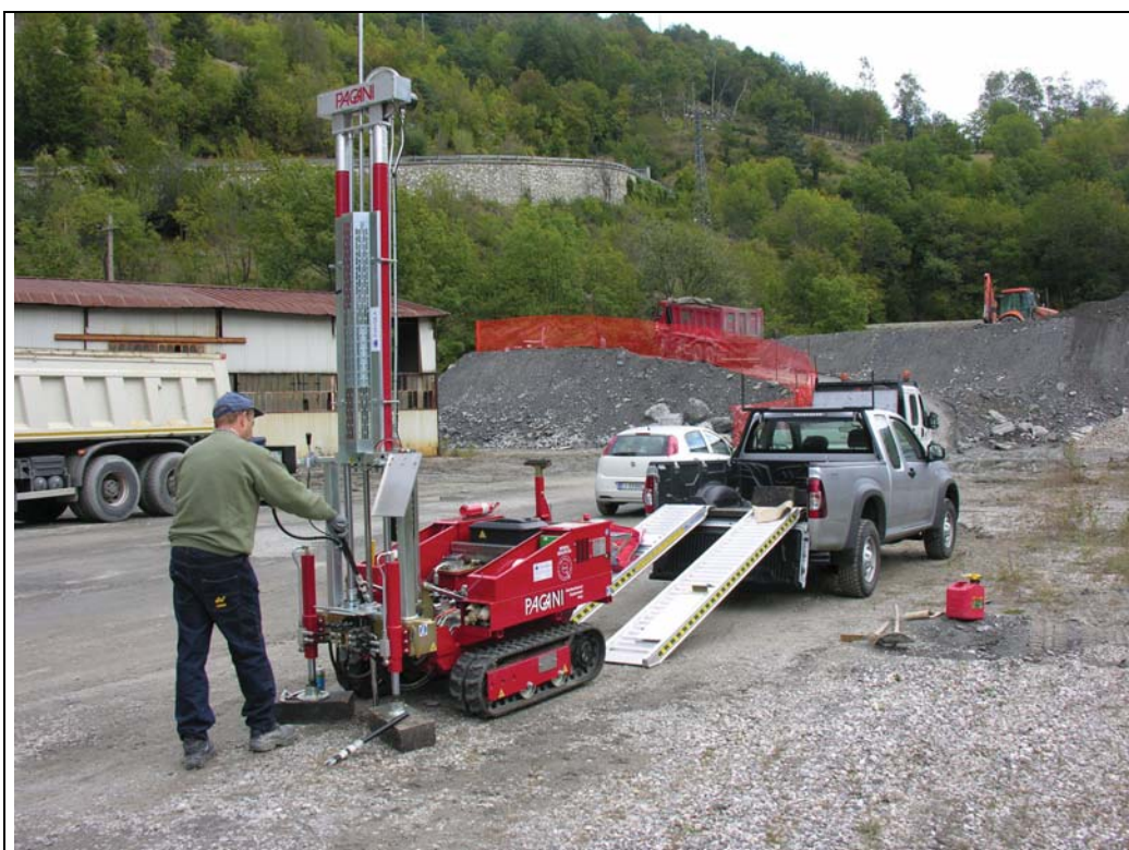
FOTO 3: esecuzione della prova penetrometrica dinamica DPSH1.
