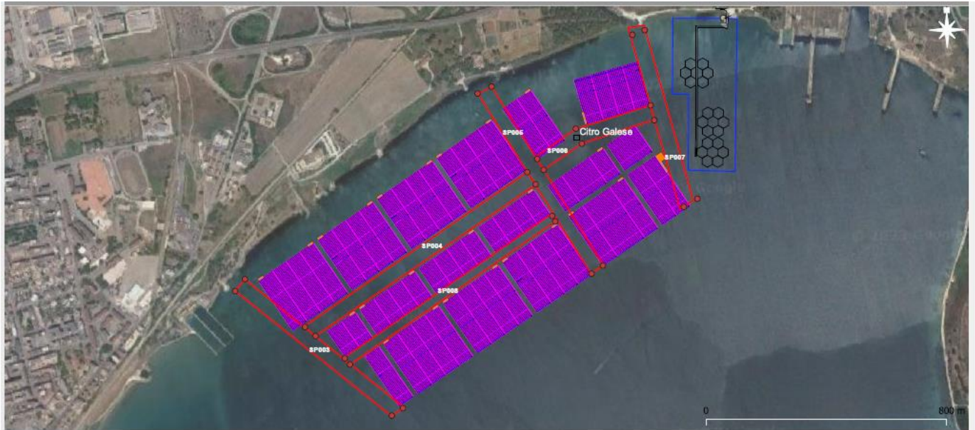
Ortofoto 1 – Disposizione dell’impianto fotovoltaico galleggiante (in verde) rispetto agli specchi acquee destinati alla mitilicoltura (in rosso)
