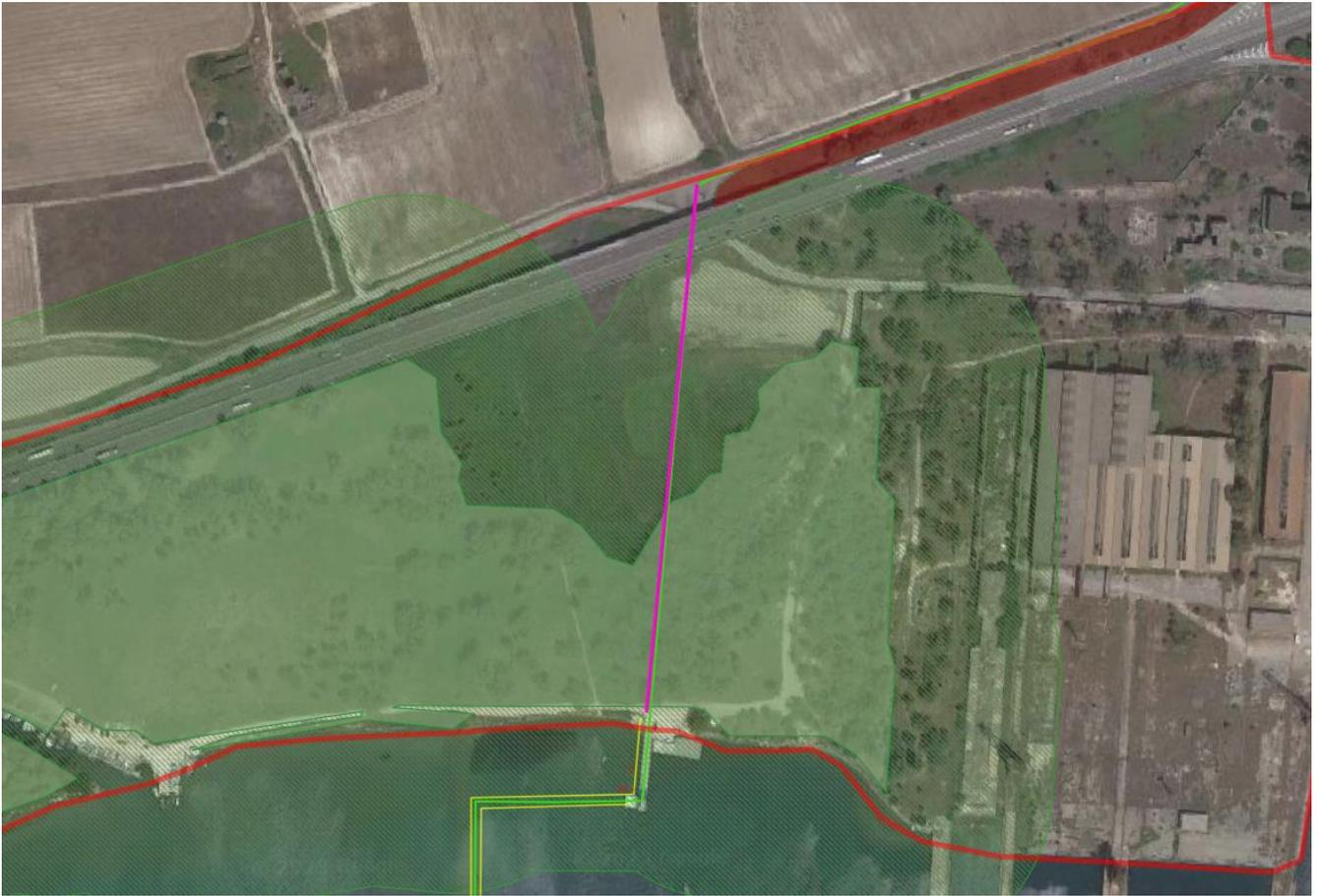
**Figura 3-8: Dettaglio della porzione di cavidotto MT interrato con tecnica TOC non invasiva (viola)**
