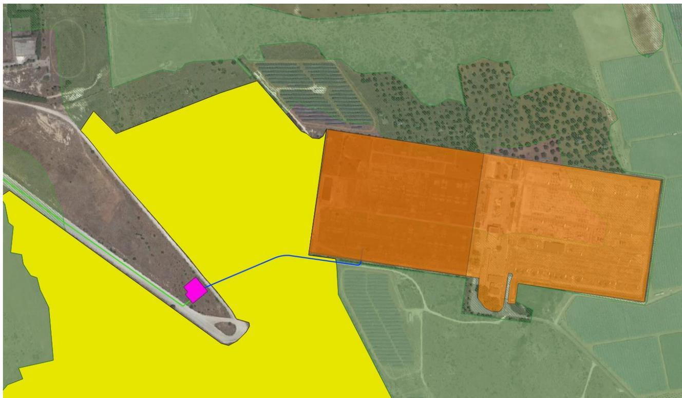
Figura 3-9: Dettaglio della porzione di cavidotto AT interrato con tecnica TOC non invasiva (Blu)
