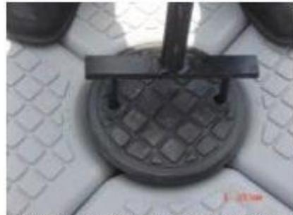
RUOTARE DI 45° IL CONNETTORE
