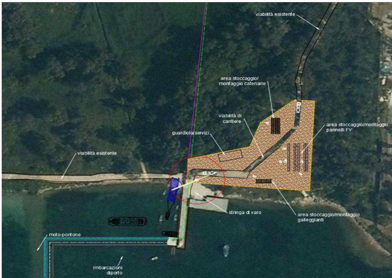
**Figura 19-4: Planimetria di cantiere**
