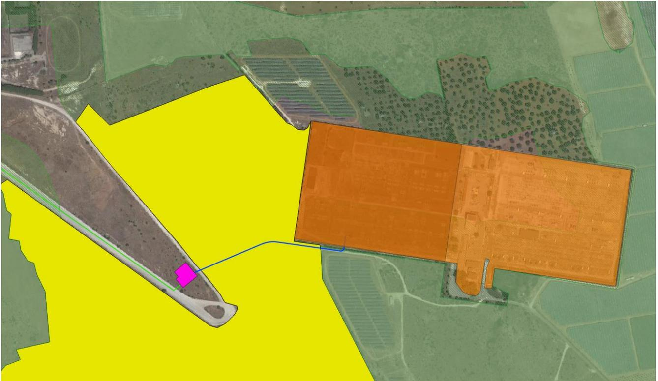
**Figura 4-18: Dettaglio della porzione di cavidotto AT interrato con tecnica TOC non invasiva (Blu)**
