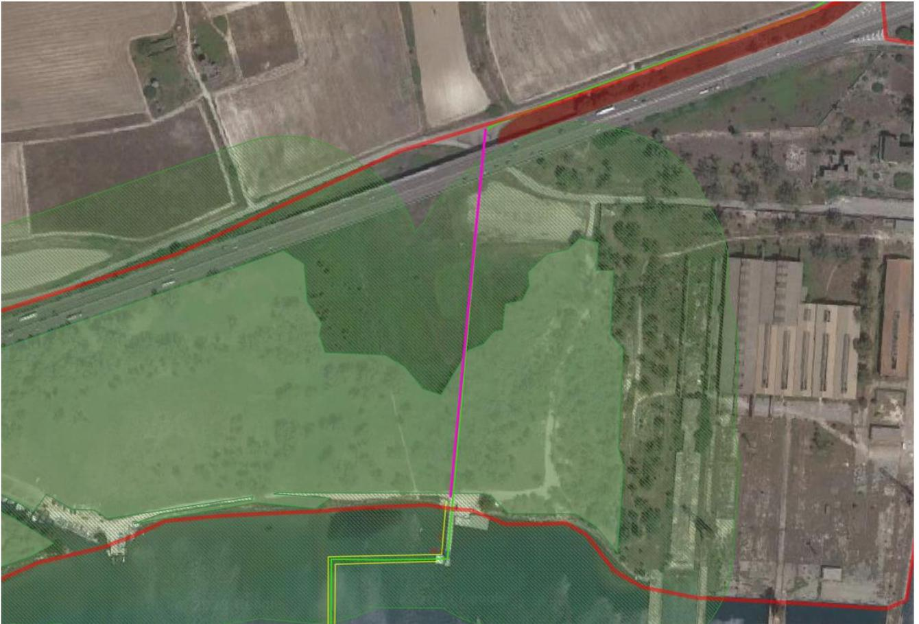
**Figura 4-17: Dettaglio della porzione di cavidotto MT interrato con tecnica TOC non invasiva (viola)**
