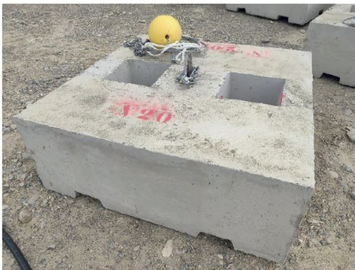
Figura 4-10: Corpo morto in cemento debolmente armato.
