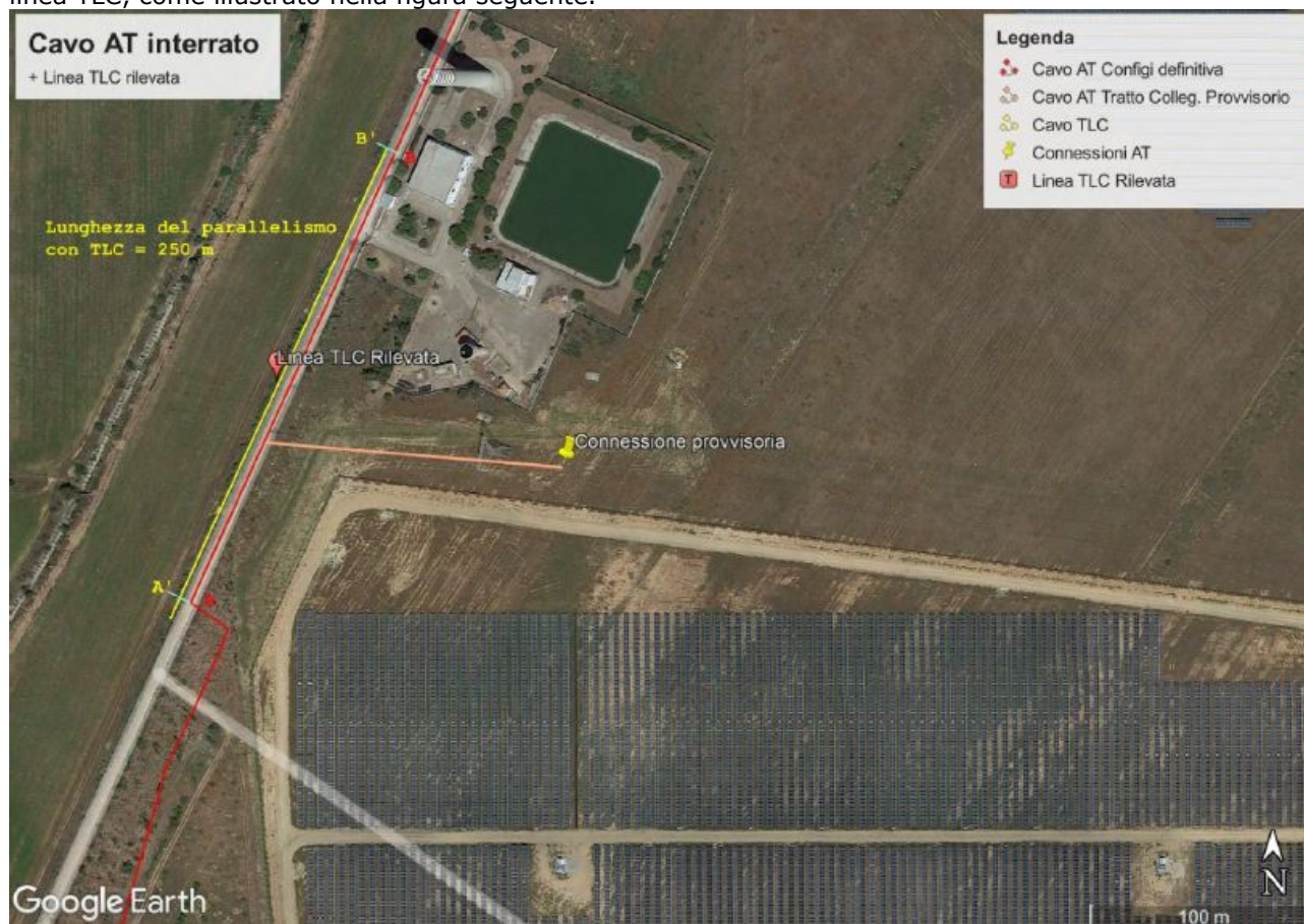
Figura 31 – Interferenza del cavo AT della connessione provvisoria con un tratto della linea TLC sulla strada Santa Lucia
