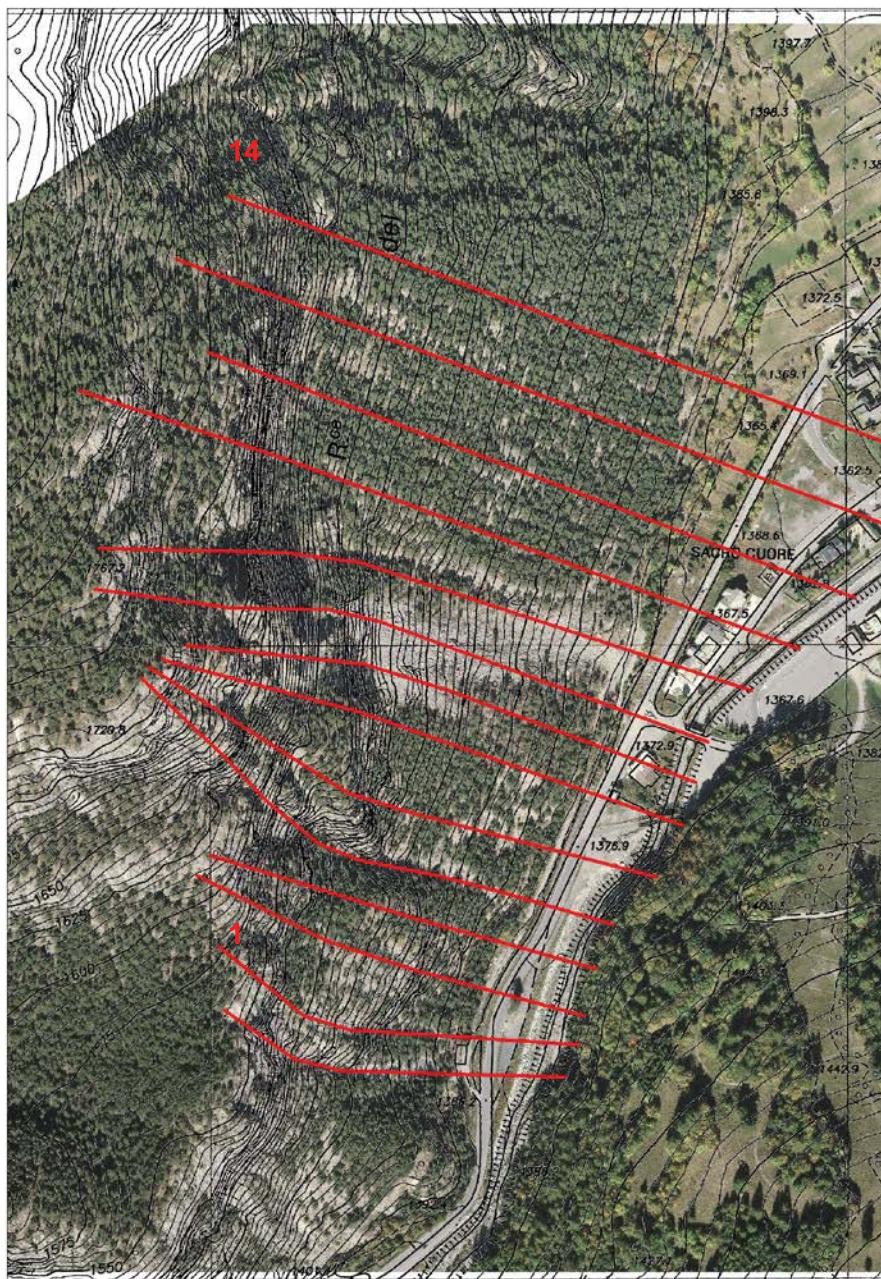
Fig. 5 – Traccia delle sezioni utilizzate per la taratura della caduta massi 2D (fenomeno 2010) e per le simulazioni su tutto il fronte di studio.
