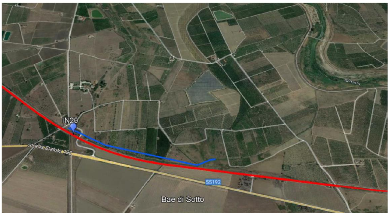
Figura 4-3 –Inquadramento IN20 – in blu il tratto oggetto di variante IN20, in azzurro il reticolo idrografico, in rosso la tratta di progetto
