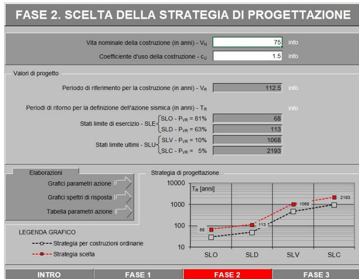
Figura 5 Vita di progetto della costruzione
