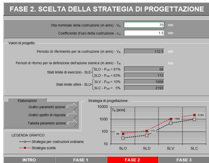
Figura 6 Vita di progetto della costruzione
