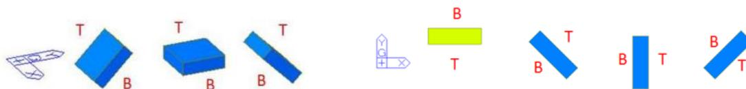
Figura 230 Definizione di Top e Bottom elementi plate tipo slab genericamente orientati
