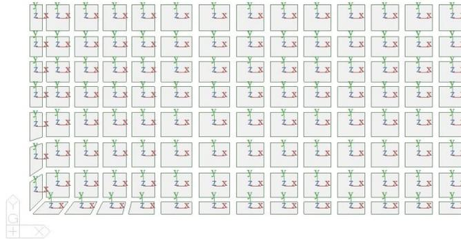
Figura 77 Assi locali gusci platea e soletta di copertura. Vista dall'alto (piano XY modello globale). Asse z positivo all'estradosso
