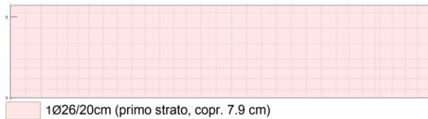
Figura 349 Armatura orizzontale lato esterno vasca
