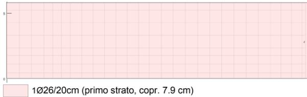
Figura 345 Armatura orizzontale lato esterno vasca
