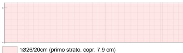
Figura 350 Armatura orizzontale lato interno vasca
