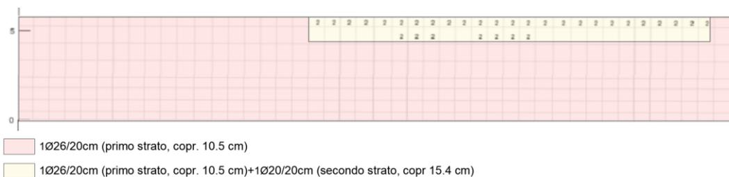
Figura 336 Armatura verticale lato interno vasca
