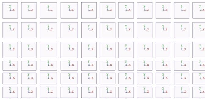
Figura 79 Assi locali gusci setti. Vista frontale nel piano XZ del setto evidenziato in rosso in Figura 78
