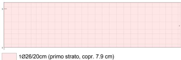
Figura 346 Armatura orizzontale lato interno vasca
