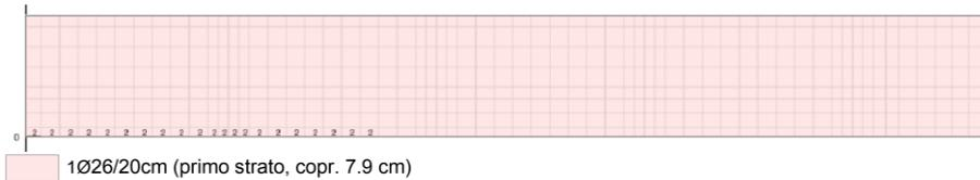
Figura 341 Armatura orizzontale lato esterno vasca
