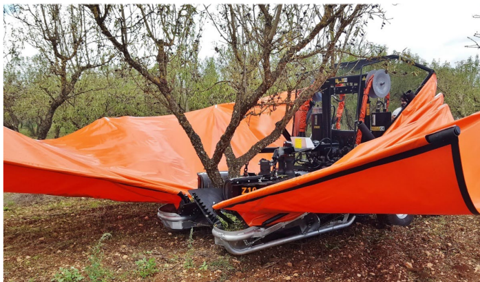
Figura 46: Macchina frontale per la raccolta delle olive/mandorle su impianto intensivo – piantine di ulivo in vivaio
