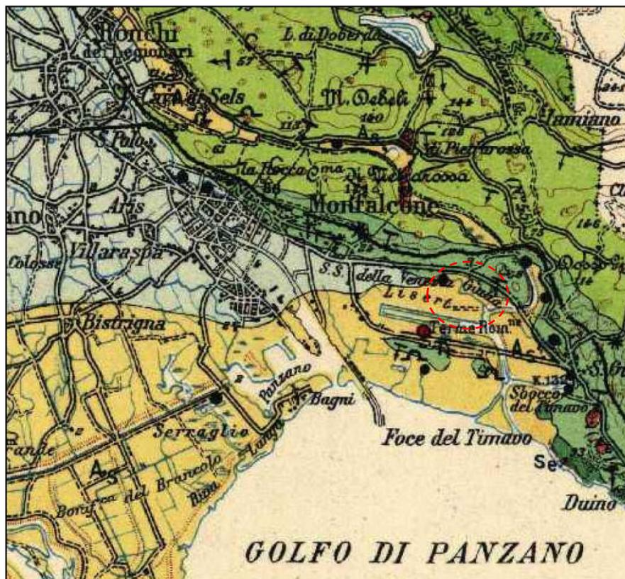
Fig. 2.1.A – Estratto da Carta geologica d'Italia, 1951 F°40 Gorizia – Complesso carbonatico: verde scuro caratterizzato da calcari grigi, talora subcristallini e verde chiaro costituito da calcari compatti e calcari dolomitici; Complesso alluvionale: azzurro costituito da alluvioni ghiaiose recenti e attuali e giallo da alluvioni sabbiose e argillose recenti e attuali. Con cerchio rosso è indicata l'area interessata dall'opera in progetto
