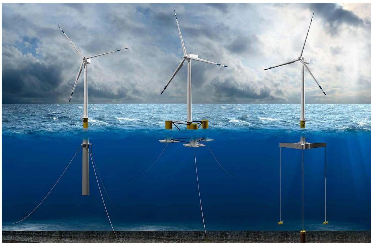
Figura 9 - Diverse tipologie di strutture galleggianti
