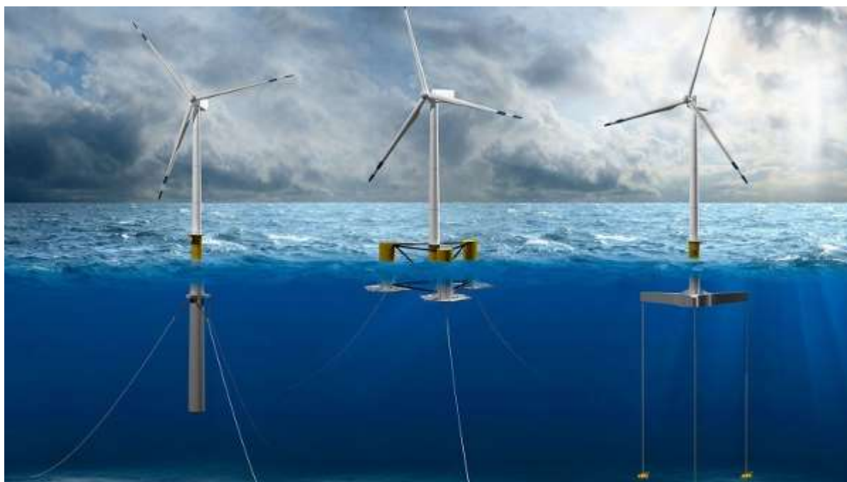
Figura 5 - Principali sistemi di ancoraggio
