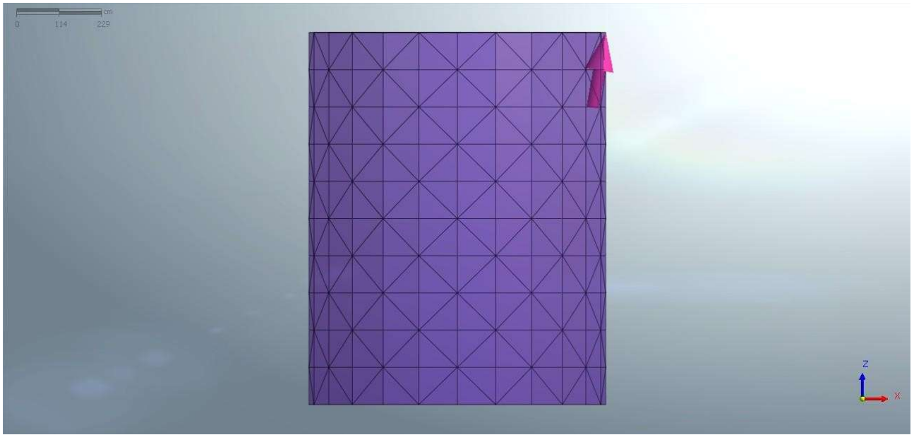
Figura 10 - Simulazione FEM di ancora Suction Bucket
