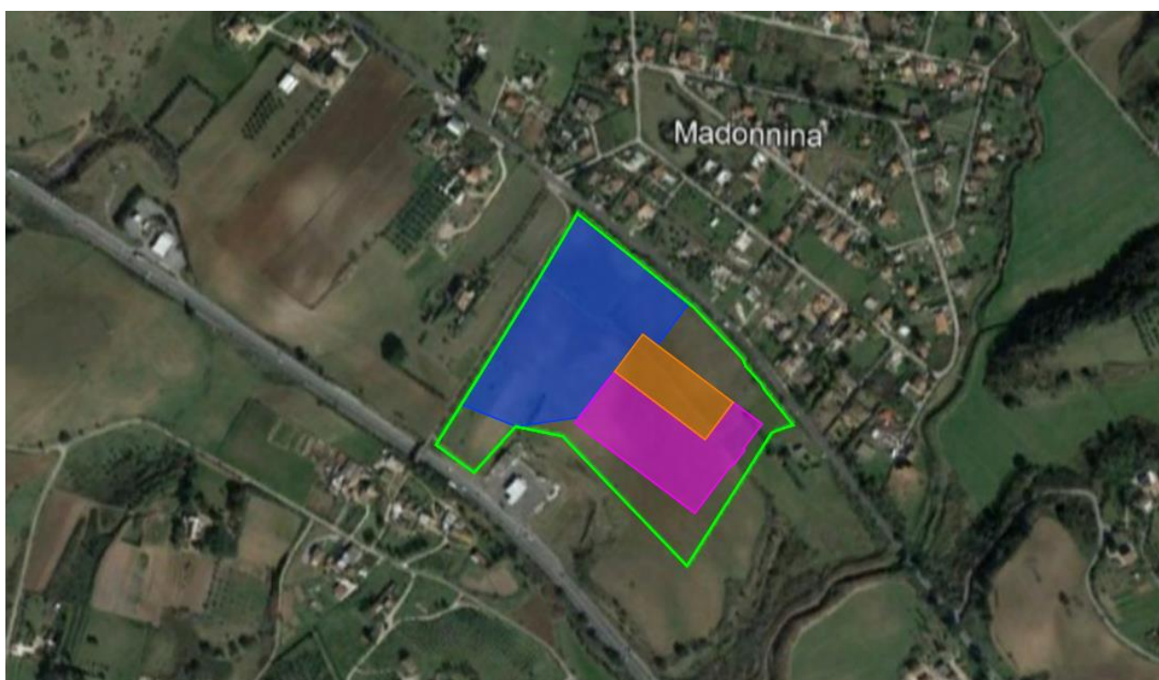
Figura 15 - Inquadramento area Stazione di Trasformazione onshore con, in verde, il confine recintato: in blu l'area di storage; in arancio l'area di connessione e in viola la trasformazione 220/380 kV
