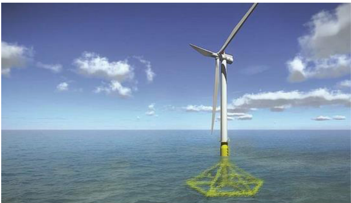
Figura 8 - Particolare della fondazione galleggiante di tipo floating
