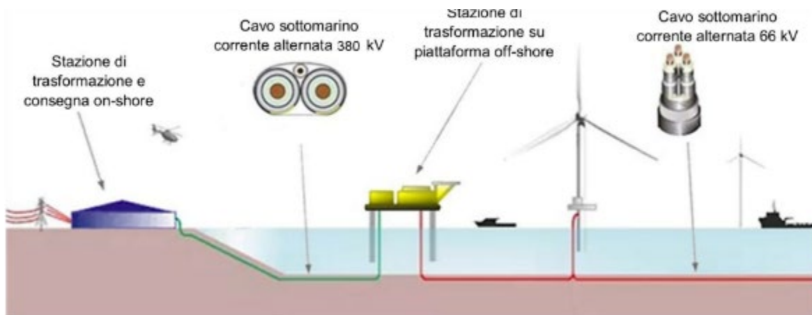
Figura 15: Schema funzionale di collegamento elettrico
