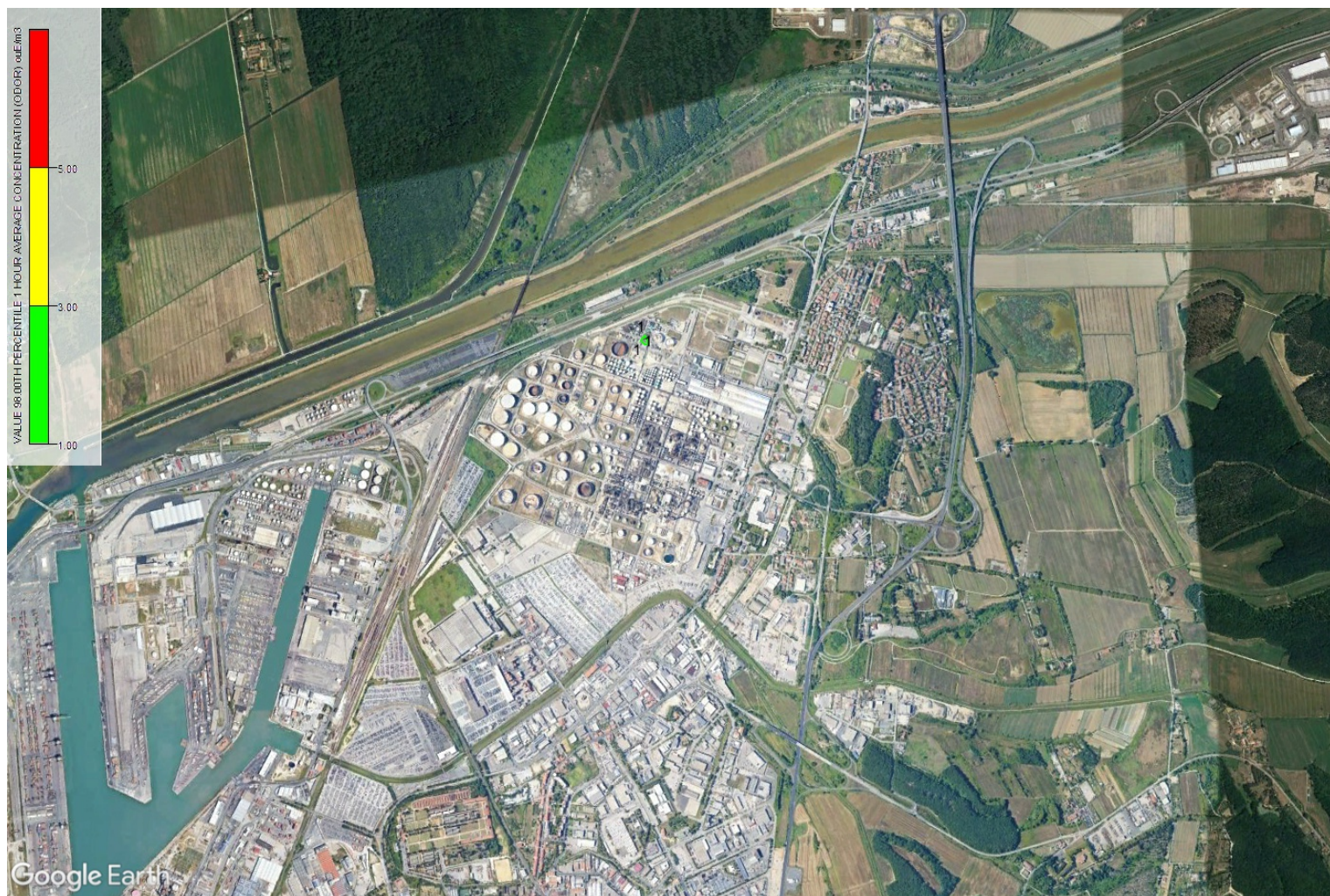
Figura 45. Concentrazione di odore al 98° percentile, sul dominio di simulazione, per il sotto-scenario serbatoi di fanghi collettati a filtri fotocatalitici
