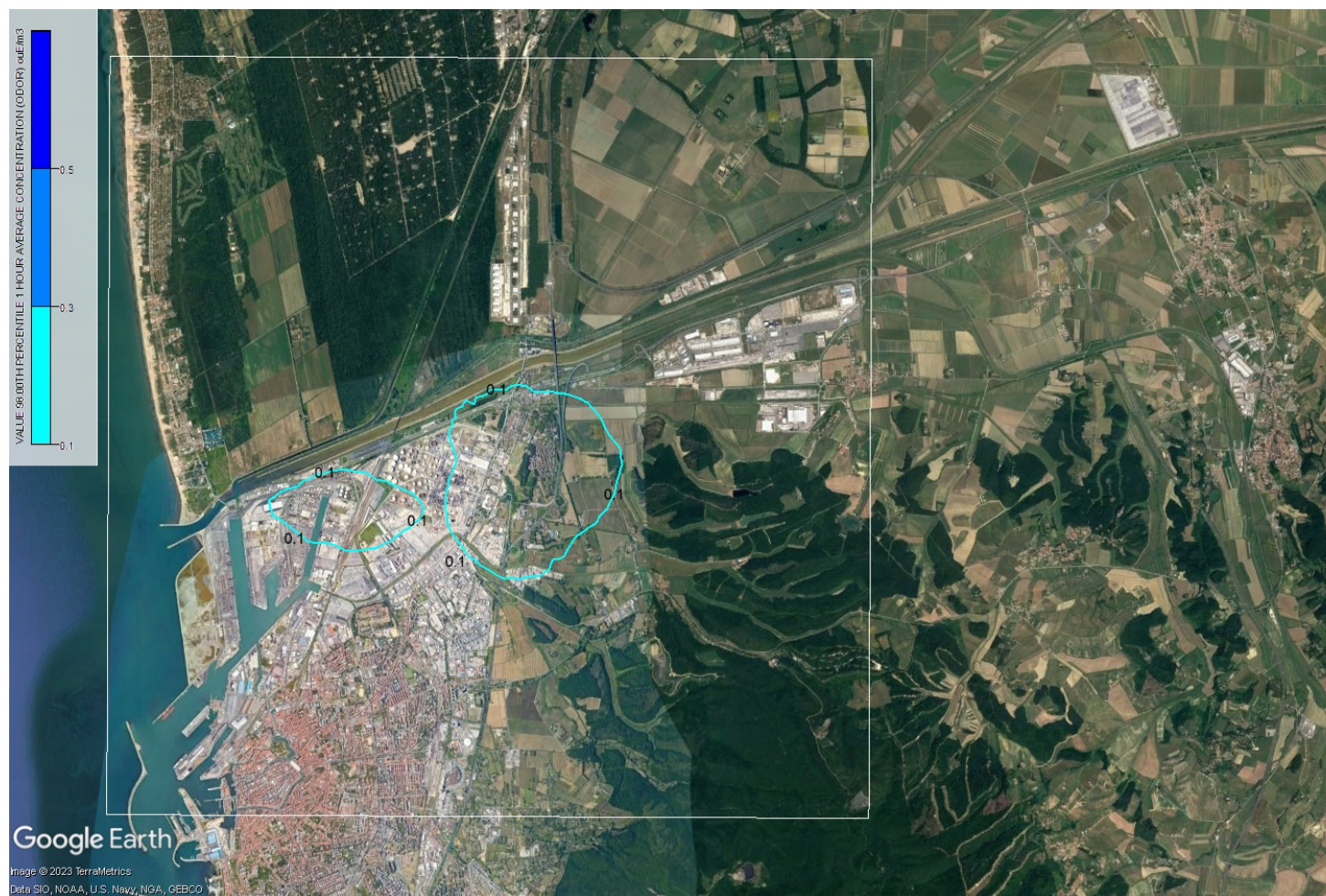
Figura 36. Concentrazione di odore al 98° percentile, sul dominio di simulazione, per il sotto-scenario camini
