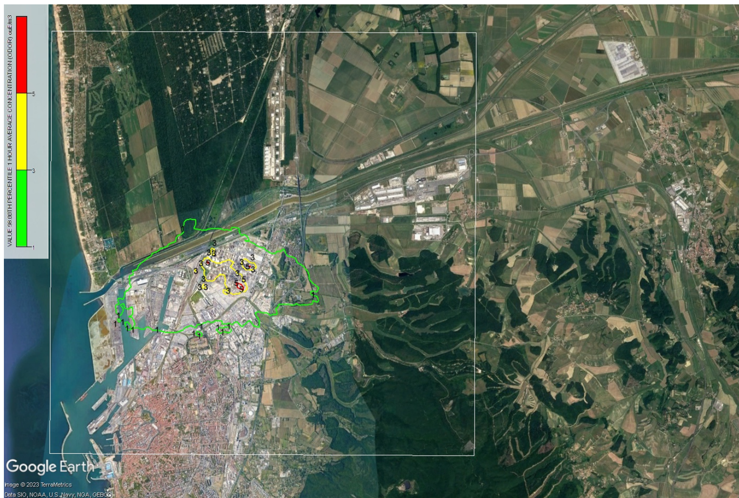
Figura 44. Concentrazione di odore al 98° percentile, sul dominio di simulazione, per il sotto-scenario serbatoi a tetto galleggiante
