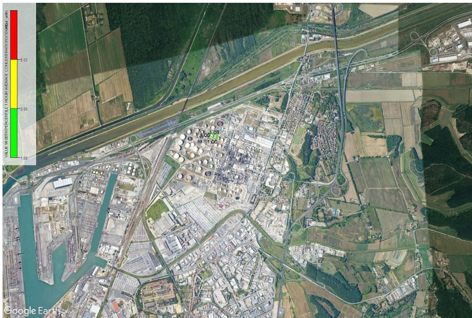
Figura 41. Concentrazione di odore al 98° percentile, sul dominio di simulazione, per il sotto-scenario serbatoi a tetto fisso non collettati
