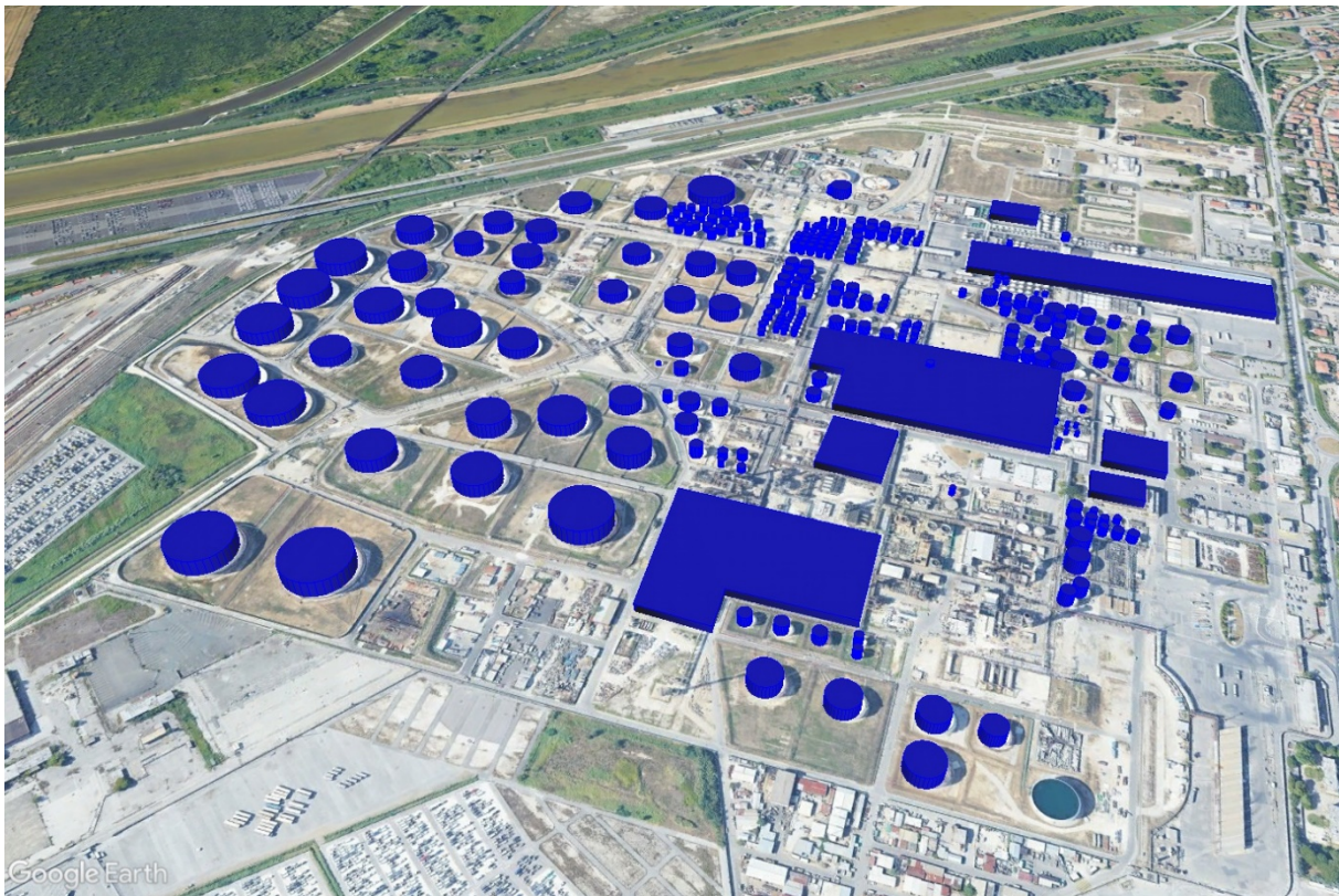
Figura 35. Simulazione visiva dei serbatoi, in blu, considerati per il calcolo del building downwash.
