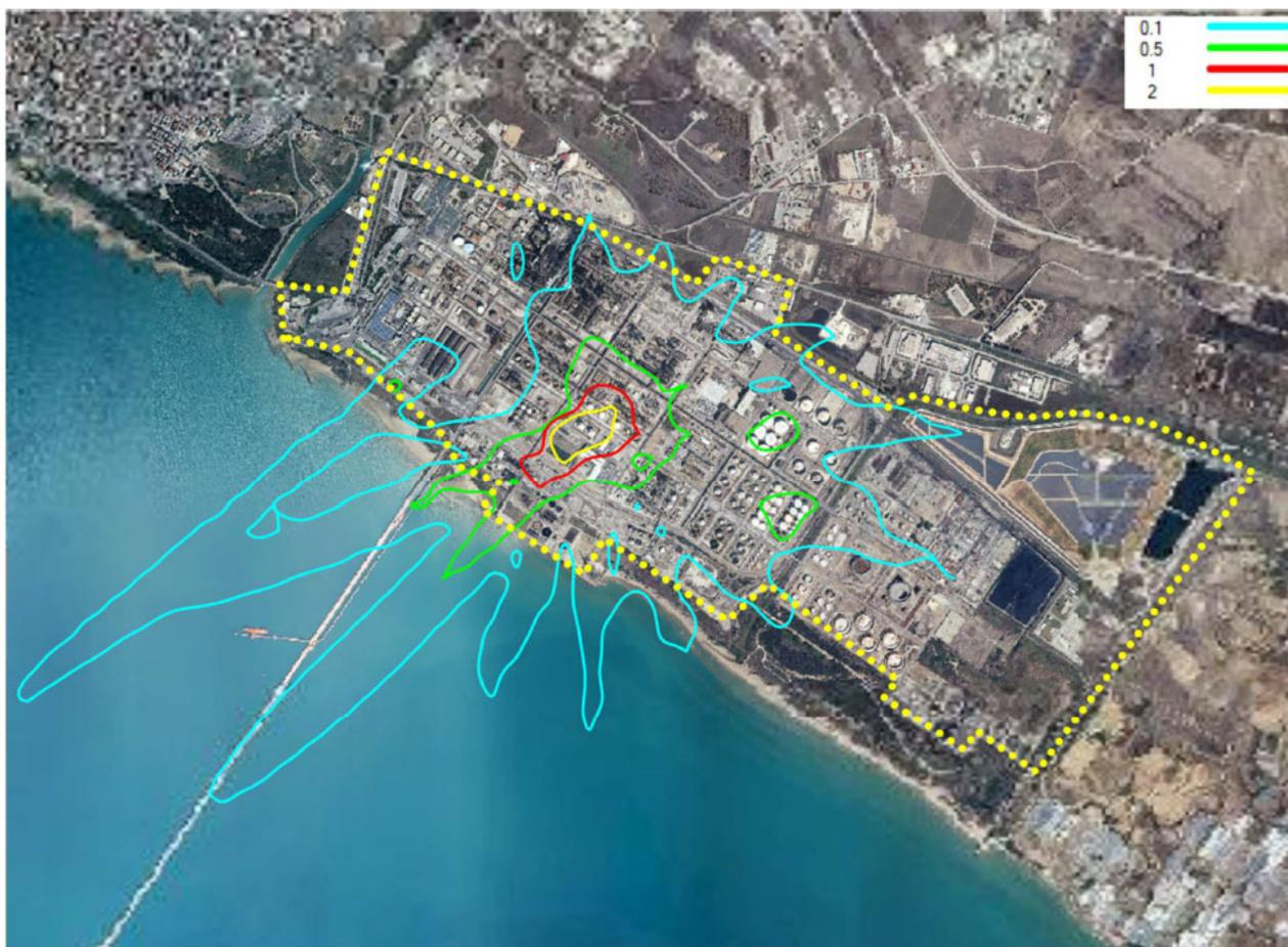
Figura 5: Concentrazione di odore 98° percentile delle medie orarie dell'anno solare 2022 simulato e valutato con coefficiente peak to mean 2.3 [Fonte: unità AMB di raffineria]
