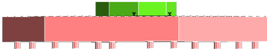
FONDAZIONE SU PALI
