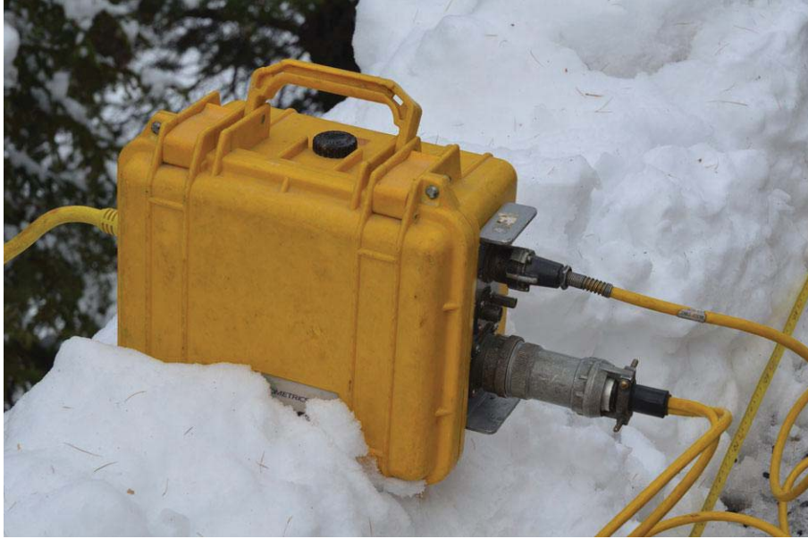
Figura 8 – Sismografo Geometrics Geode.
