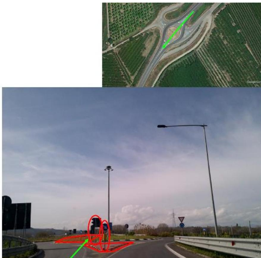
Figura 19: Punto di ripresa P9.01 (612295.00 m E 4397569.00 m N) - L'isola spartitraffico con tutta la segnaletica stradale deve essere rimossa. Il lato sinistro della rotatoria deve essere allargato e reso praticabile.
