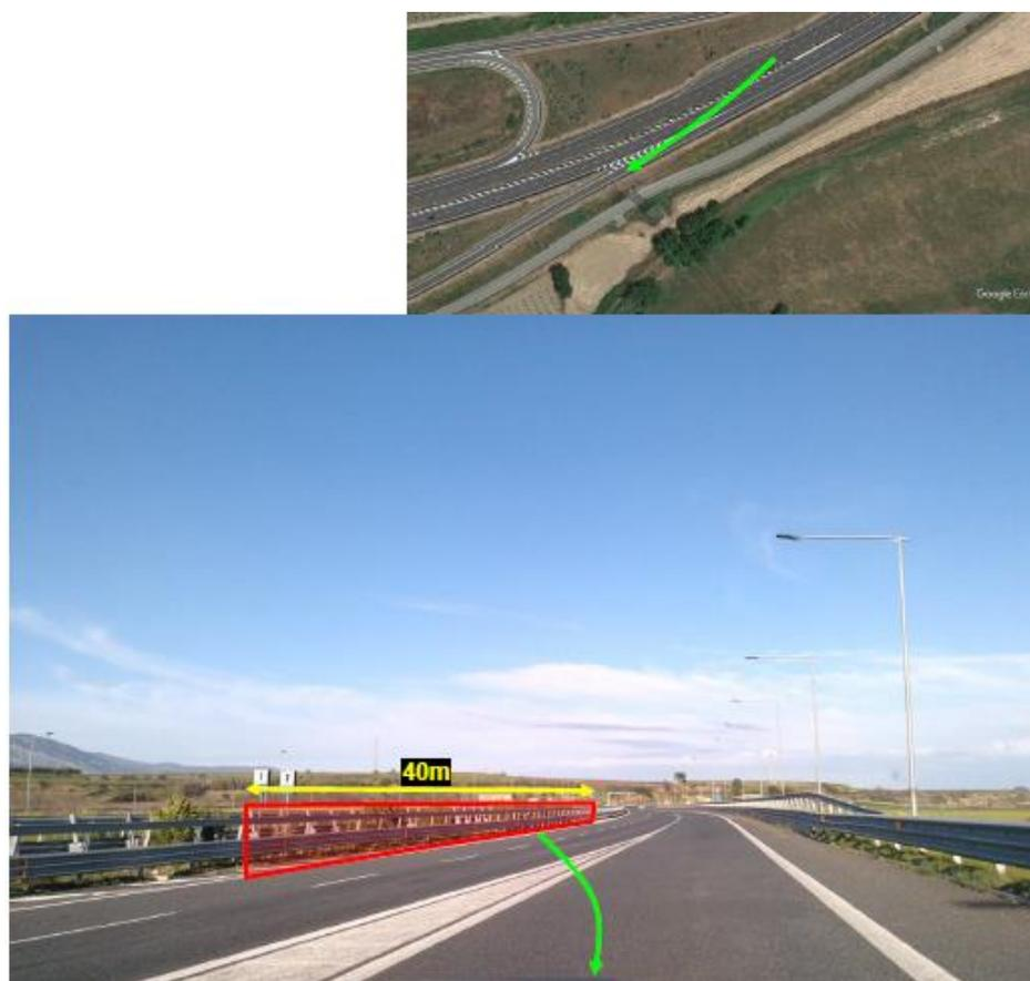
Figura 17: Punto di ripresa P8.01 (613049.54 m E 4397949.95 m N) - È necessario rimuovere il guardrail per 40 metri per mantenere per consentire il transito nel senso di marcia opposto.
