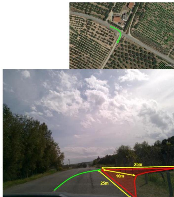
Figura 27: Punto di ripresa P15 (614035.36 m E 4396507.42 m N) – Per consentire la svolta a destra bisognerà intervenire con lavori di adeguamento della viabilità.
