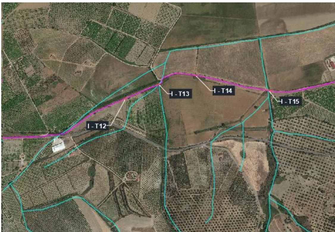
Figura 71: Primo inquadramento su base ortofoto del layout in progetto con l'indicazione dei punti in cui si rileva l'interferenza con gli elementi idrici (I - Txx).
