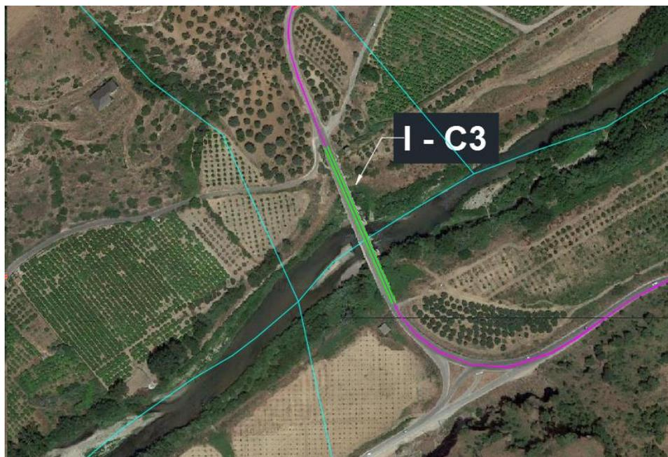
Figura 86: Inquadramento su base ortofoto del layout in progetto con l'indicazione dei punti in cui si rileva l'interferenza con gli elementi idrici (I - Cxx).
