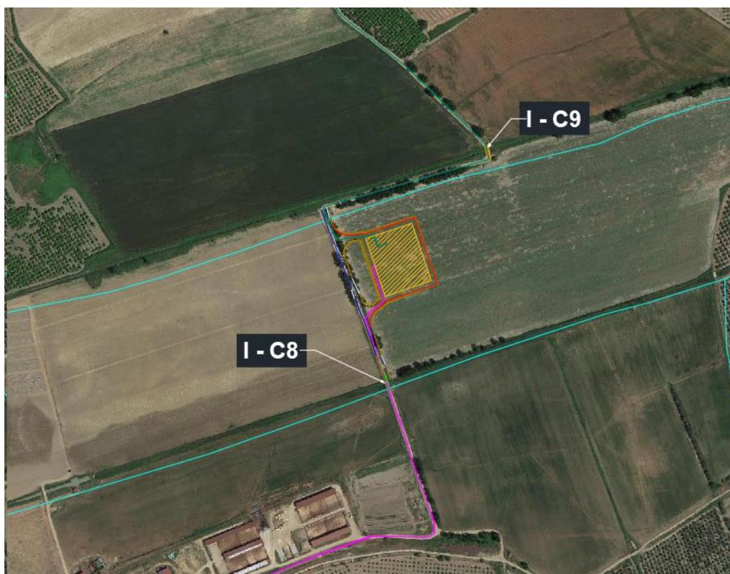
Figura 93: Inquadramento su base ortofoto del layout in progetto con l'indicazione dei punti in cui si rileva l'interferenza con gli elementi idrici (I - Cxx).
