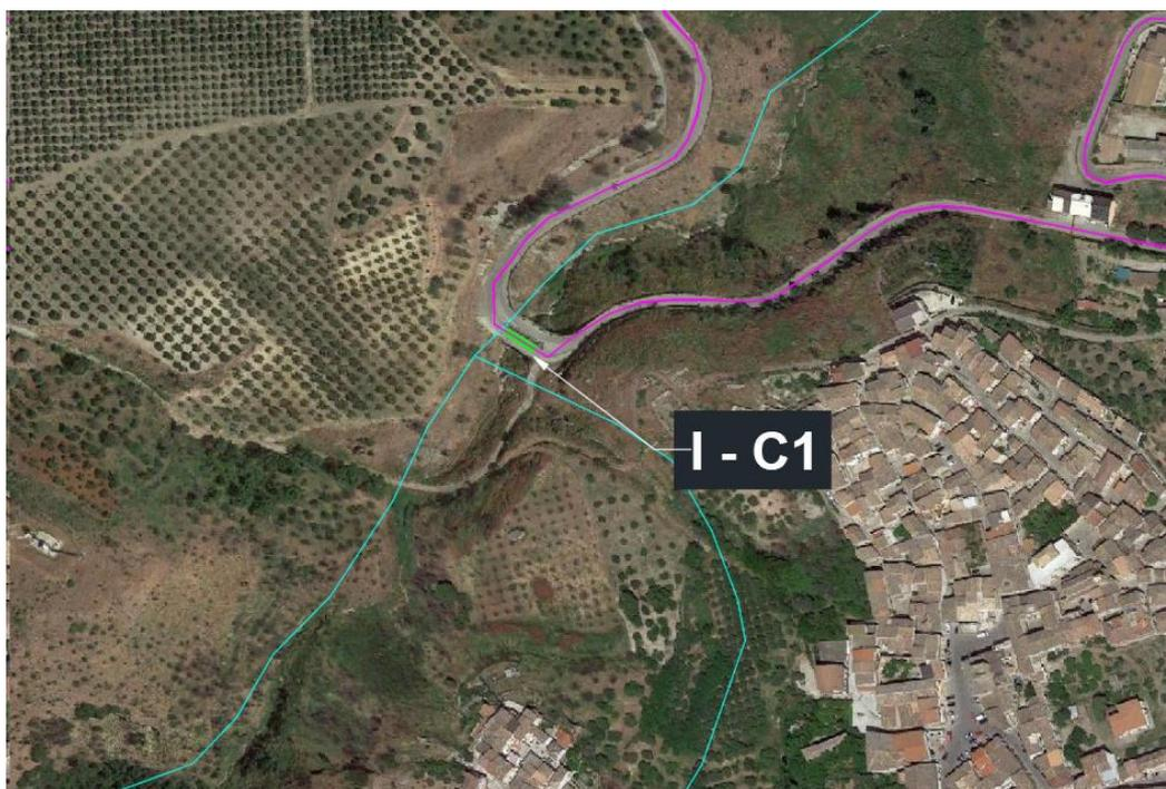
Figura 82: Inquadramento su base ortofoto del layout in progetto con l'indicazione dei punti in cui si rileva l'interferenza con gli elementi idrici (I - Cxx).
