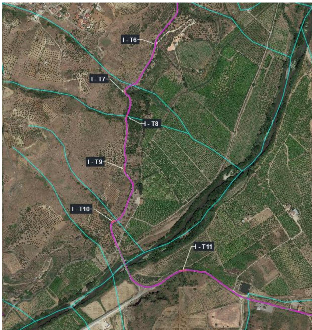
Figura 65: Primo inquadramento su base ortofoto del layout in progetto con l'indicazione dei punti in cui si rileva l'interferenza con gli elementi idrici (I - Txx).
