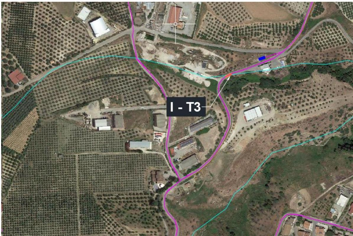
Figura 60: Primo inquadramento su base ortofoto del layout in progetto con l'indicazione dei punti in cui si rileva l'interferenza con gli elementi idrici (I - Txx).
