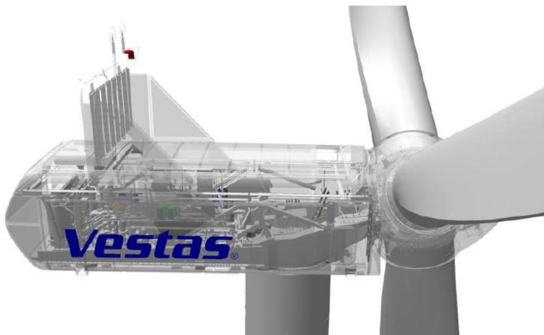
Figura 8: Allestimento navicella aerogeneratore
