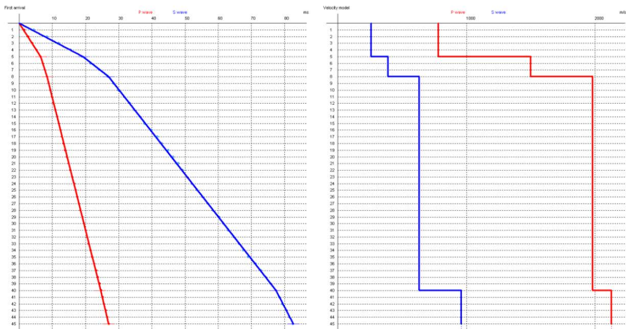
Fig. 38 – Dromocrone tempi profondità e profilo di velocità ( in blu onde P, in rosso onde S) SI 1 DH
