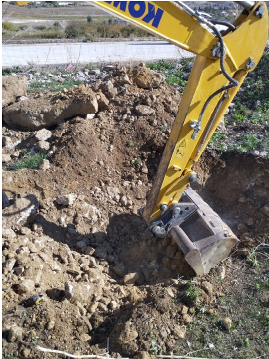
Figura 2.1.a: Esempio campionamento ambientale terre
