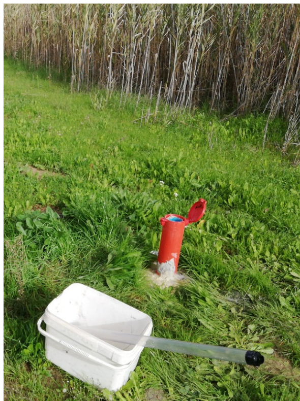
Figura 2.2.a: Esempio campionamento ambientale acque sotterranee
