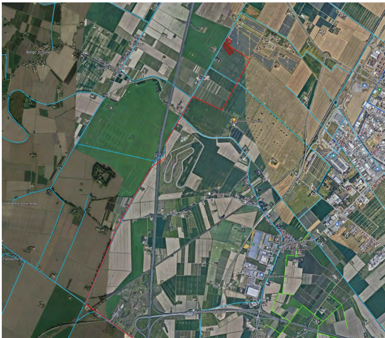
Figura 11: Rete dei canali consortili, in rosso il tracciato dell'elettrodotto MT e la cabina Aranova
