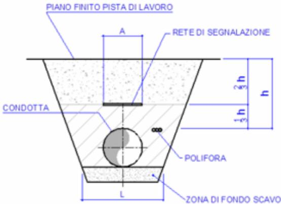
**Figura 2.1-B: sezione rinterri trincea di posa**
