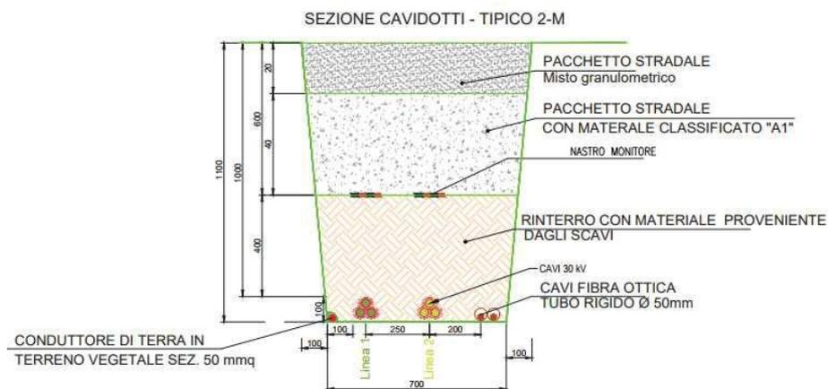
Figura 18- Sezione tipo di scavo – doppia terna MT su strada sterrata
