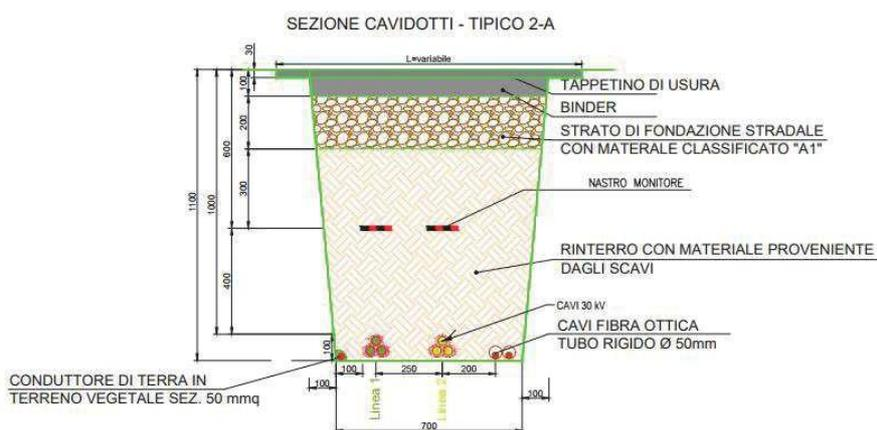
Figura 19- Sezione tipo di scavo – doppia terna MT su strada asfaltata (comunale)
