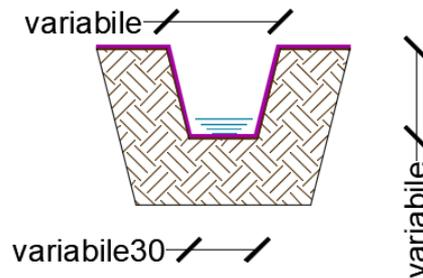
**Opere di dissipazione:** tali opere sono poste al termine degli scarichi, in modo tale da ridurre l'energia della corrente idrica reimpressa negli impluvi naturali e limitare quindi l'erosione dei versanti. Sono previste opere di dissipazione con pietrame di grandi dimensioni ( $D > 40$  cm), con differente geometria in funzione delle caratteristiche della corrente in uscita e del corpo idrico ricettore.
