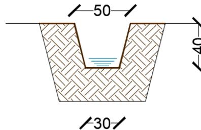
In alcuni tratti – con pendenze superiori al 10% - tali fossi di guardia possono presentare il **fondo rivestito con pietrame** di media pezzatura ( $d=5-10$  cm), per uno spessore di 15 cm, al fine di ridurre l'azione erosiva della corrente idrica.
