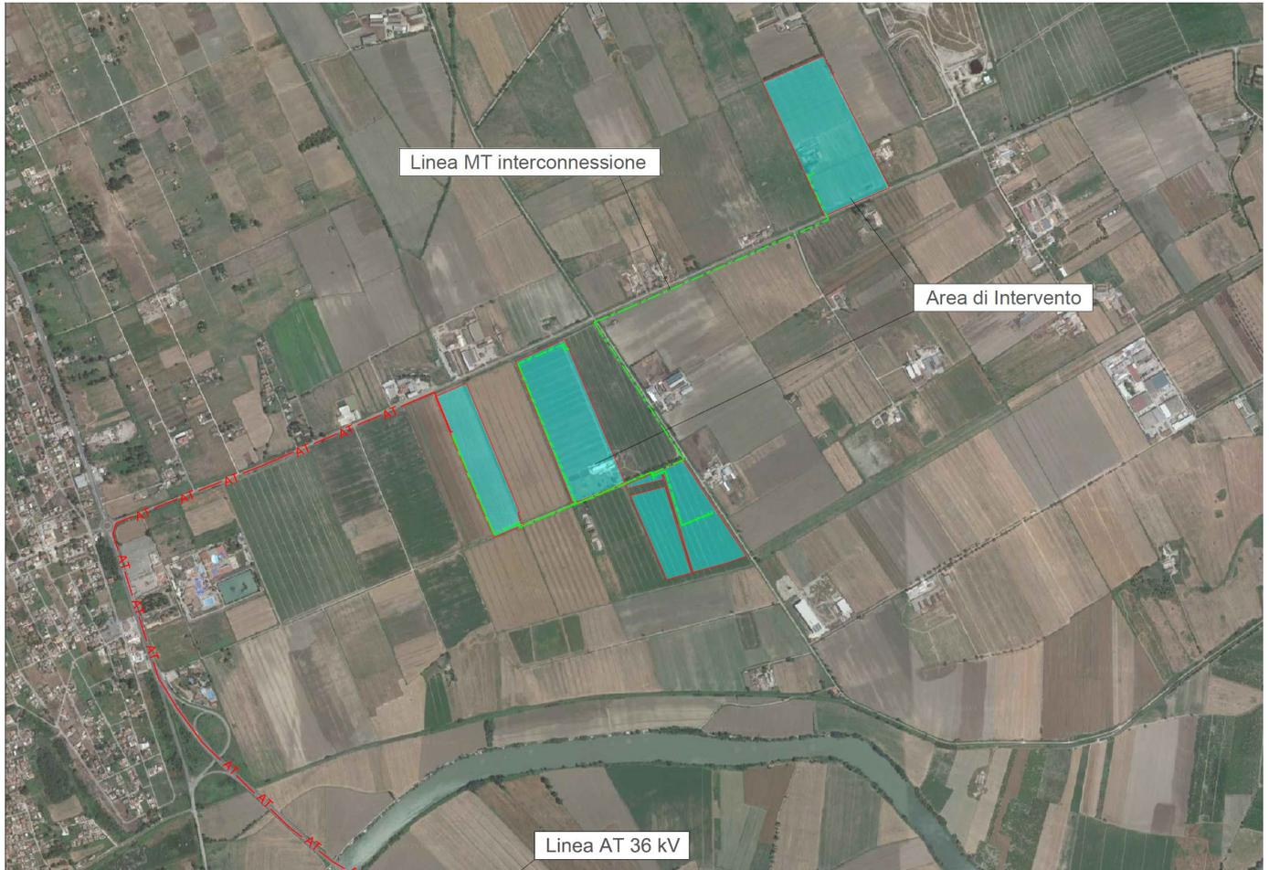
**Ortofoto con indicazione del Parco Fotovoltaico e del cavidotto di connessione alla futura Stazione Elettrica (SE) Terna della RTN a 380/150/36 kV da collegare in entra-esce alla linea RTN 380 kV “Garigliano-ST Patria”**
