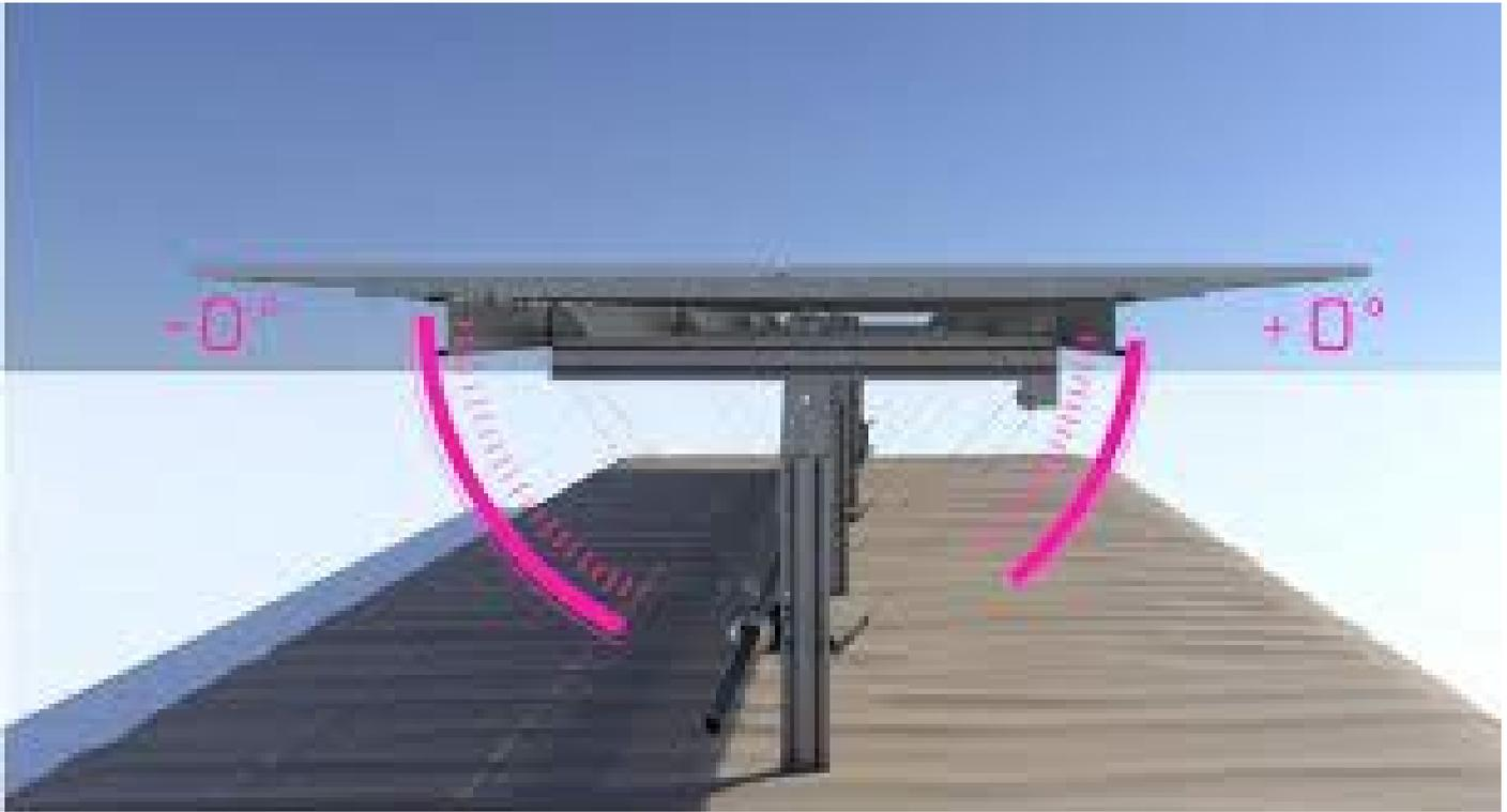
Il sistema di ancoraggio è pensato specificatamente per velocizzare e semplificare la problematica relativa alla installazione degli impianti a terra. Il fissaggio al suolo sarà effettuato mediante paletti infissi nel terreno, per una lunghezza, stimata in circa 2 metri, ma comunque variabile sulla base delle risultanze dei calcoli esecutivi sulle strutture, verificati sul campo con test di estrazione, pertanto privi di qualsiasi tipo di fondazione in calcestruzzo armato.
