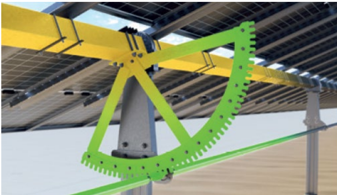
Dettaglio movimentazione con inseguitore monoassiale Est-Ovest
