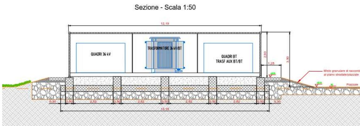
Figura 10.2: Sezione Cabina di Trasformazione
