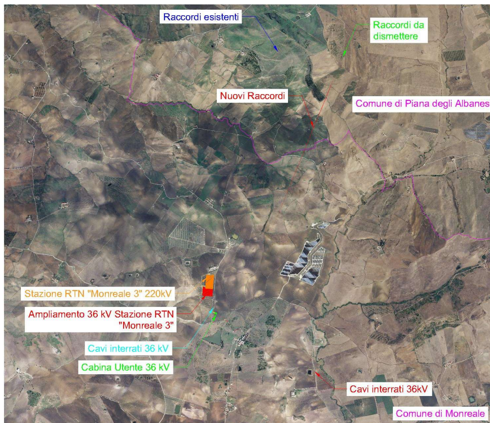
Figura 3-3 – Inquadramento su ortofoto – Area opere di connessione
